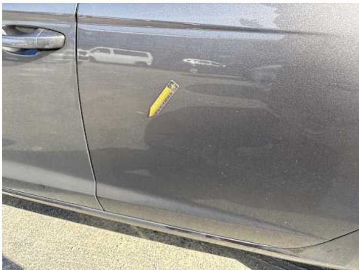
Türe hinten links (Kratzer)
