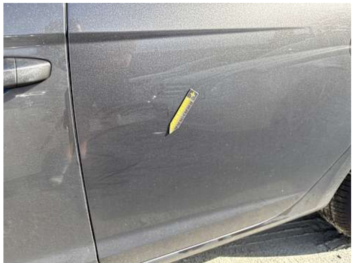
Türe hinten links (Kratzer)
