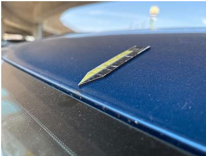
Dach (Rost, Lackschaden)
