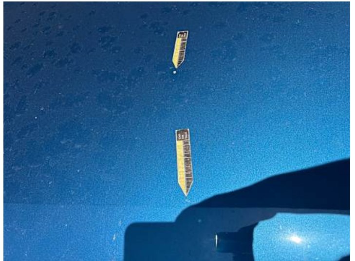
Motorhaube (Steinschlag, Lackschaden, Unsachgemäß instand gesetzt)
