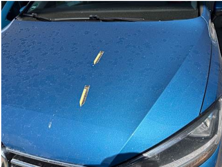
Motorhaube (Steinschlag, Lackschaden, Unsachgemäß instand gesetzt)
