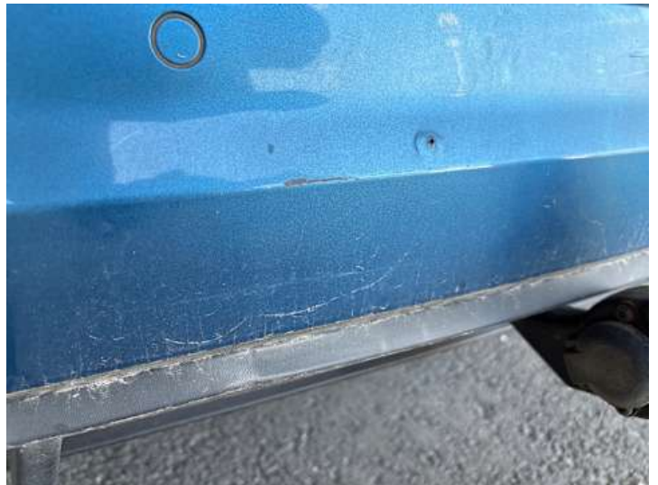
Stoßstange hinten (Verformung, Lackschaden, Kratzer)
