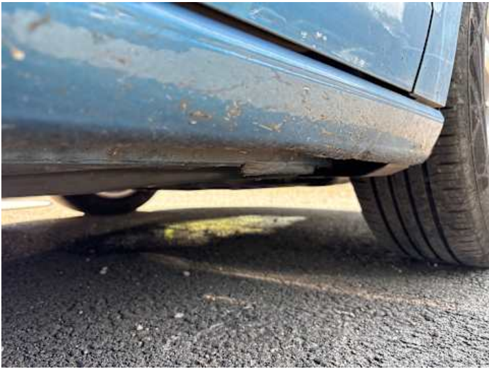
Schweller rechts (Verformung)
