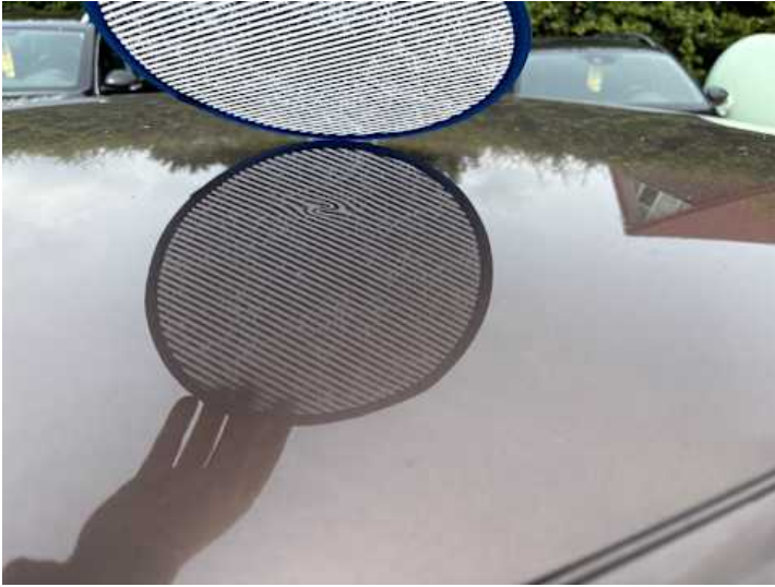
Dach (Lackschaden, Rost, Delle)
