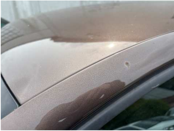
Dach (Lackschaden, Rost, Delle)
