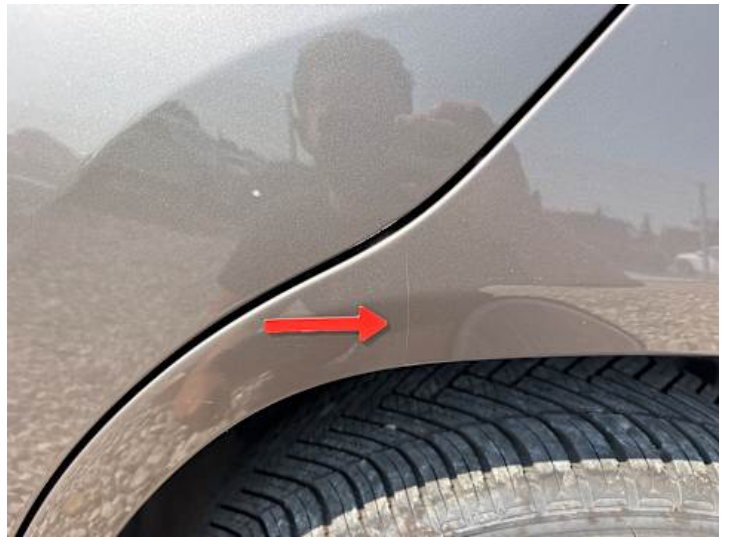
Seitenteil hinten links (Kratzer, Lackschaden, Rost)
