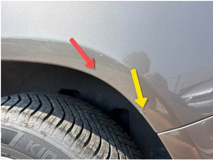
Seitenteil hinten links (Kratzer, Lackschaden, Rost)
