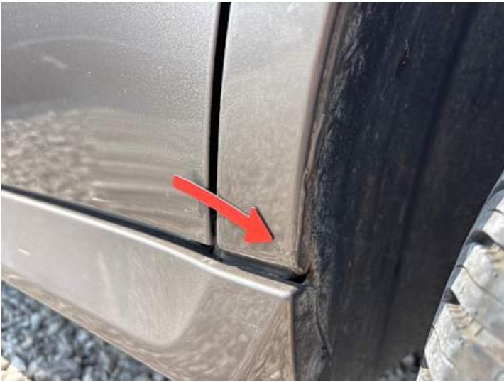
Seitenteil hinten links (Kratzer, Lackschaden, Rost)
