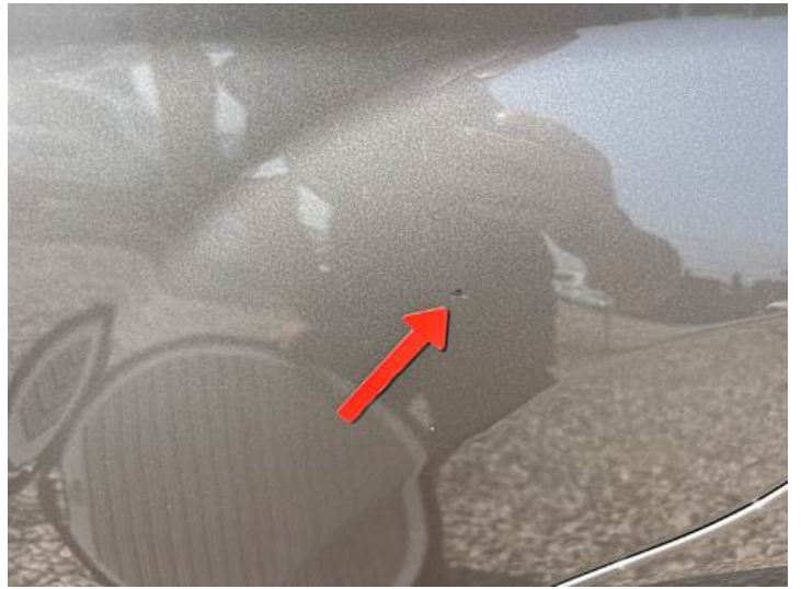
Türe hinten links (Lackschaden, Unsachgemäß instand gesetzt)
