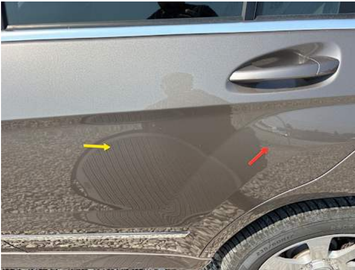
Türe hinten links (Lackschaden, Unsachgemäß instand gesetzt)
