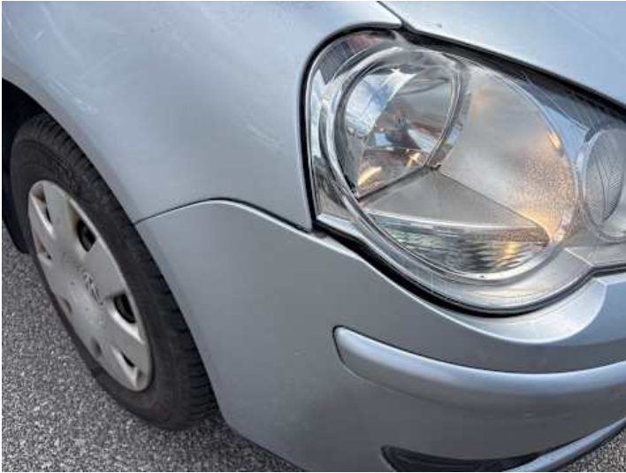
Stoßstange vorne (Unsachgemäß instand gesetzt, Riss/Bruch, Spaltmaße ungenau)
