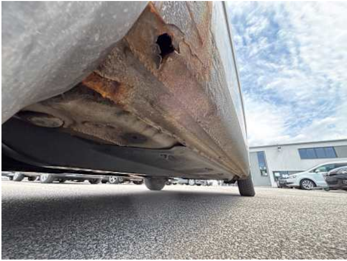
Schweller links (Rost, Unsachgemäß instand gesetzt)
