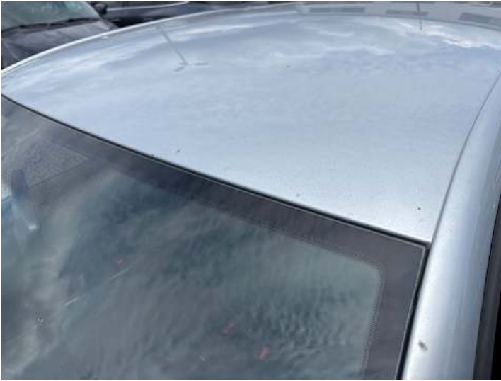
Dach (Steinschlag, Rost)
