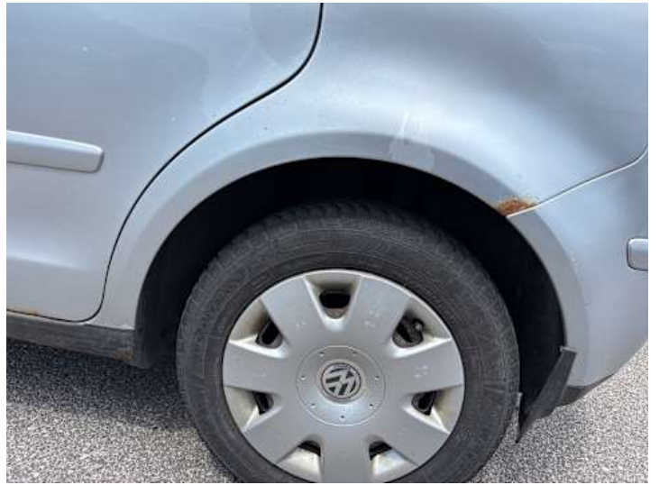
Seitenteil hinten links (Rost, Unsachgemäß instand gesetzt, Delle)
