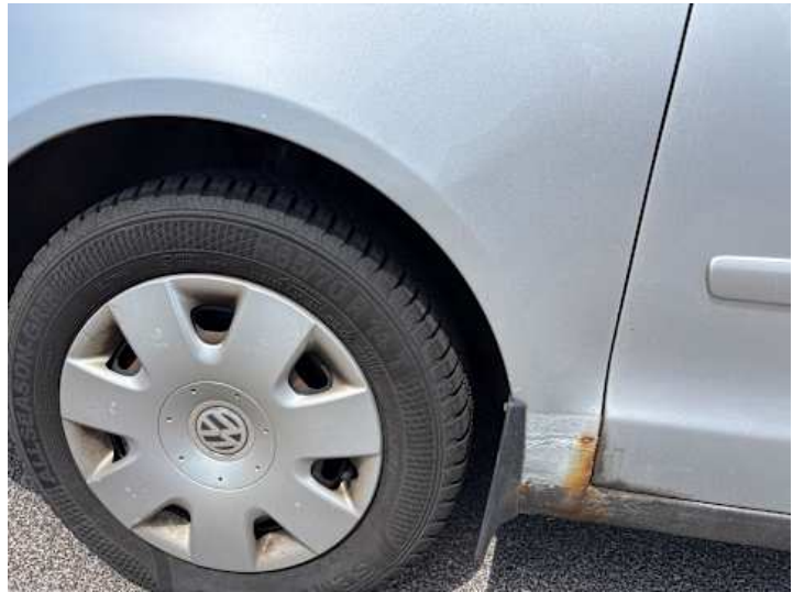
Kotflügel vorne links (Rost)
