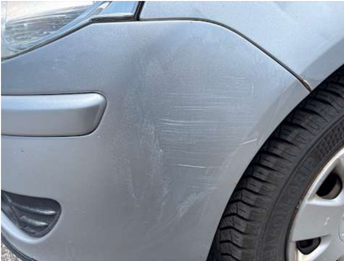
Stoßstange vorne (Unsachgemäß instand gesetzt, Riss/Bruch, Spaltmaße ungenau)
