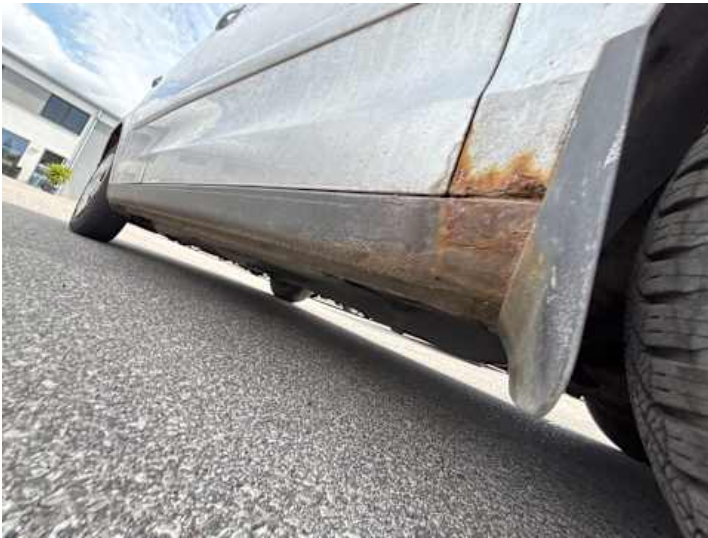
Schweller rechts (Rost, Unsachgemäß instand gesetzt)
