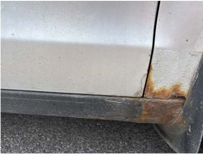
Beifahrertür (Unsachgemäß instand gesetzt)
