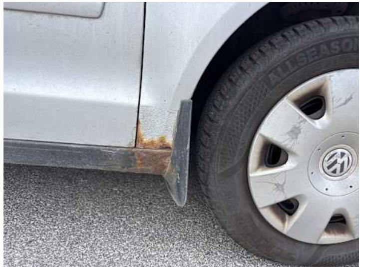
Kotflügel vorne rechts (Unsachgemäß instand gesetzt, Rost)
