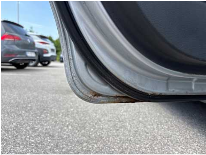
Türe hinten links (Rost)
