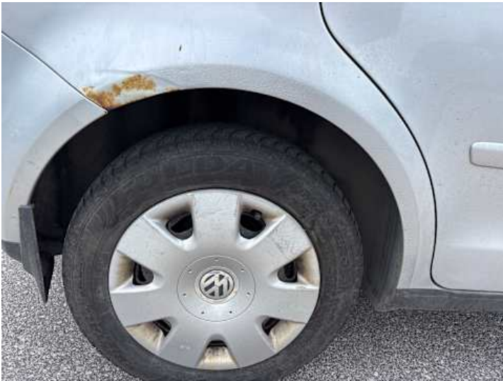
Seitenteil hinten rechts (Rost, Unsachgemäß instand gesetzt)
