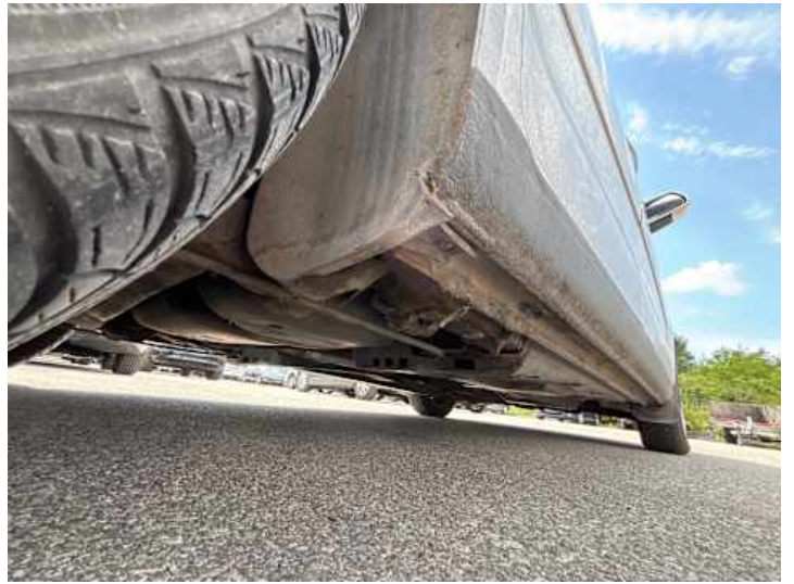
Schweller rechts (Rost, Unsachgemäß instand gesetzt)
