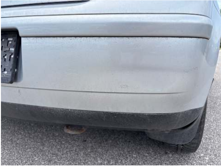
Stoßstange hinten (Unsachgemäß instand gesetzt, Lackschaden)
