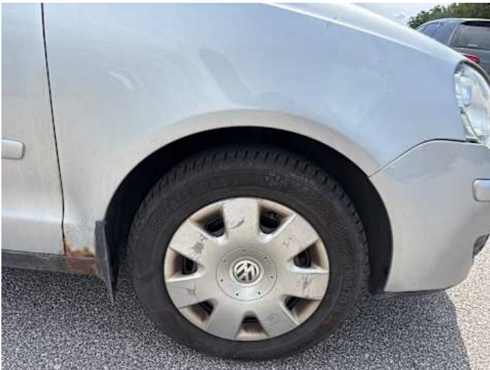
Kotflügel vorne rechts (Unsachgemäß instand gesetzt, Rost)
