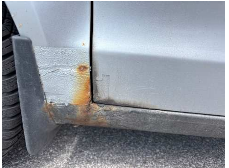
Fahrtür (Unsachgemäß instand gesetzt)
