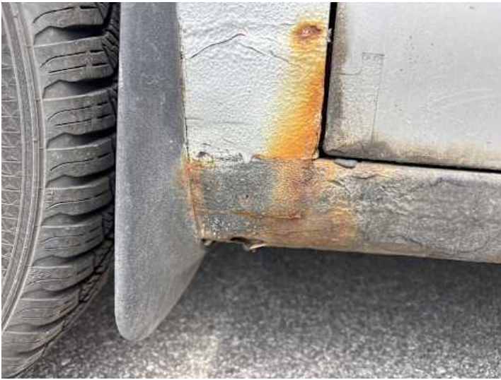
Schweller links (Rost, Unsachgemäß instand gesetzt)
