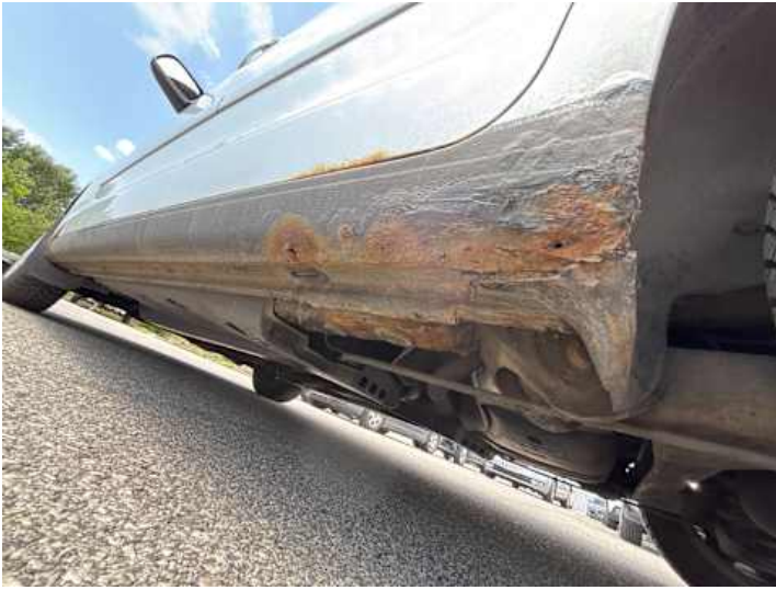
Schweller links (Rost, Unsachgemäß instand gesetzt)
