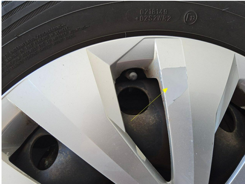
Bild 22 : Diverse Gebrauchsspuren, Kratzer, Dellen und Umweltbeaufschlagung rundum Radabdeckung vorne links
