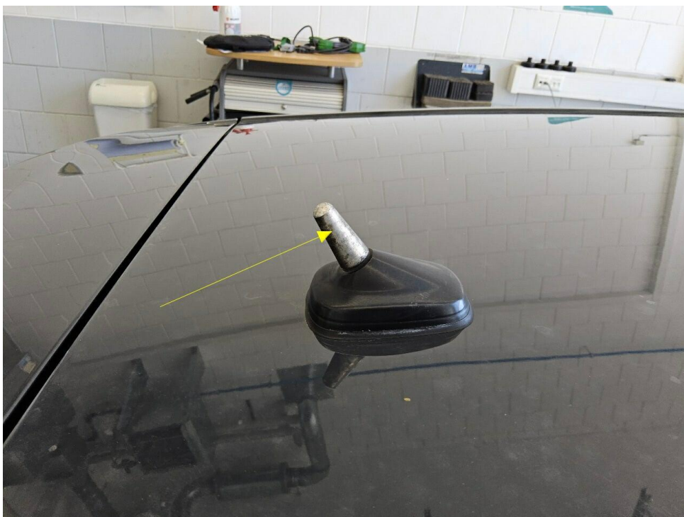
Bild 17 : Diverse Gebrauchsspuren, Kratzer, Dellen und Umweltbeaufschlagung rundum Antennenstab
