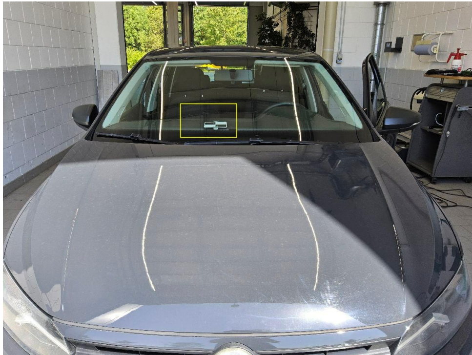
Bild 8 : Windschutzscheibe Steinschlag mit Rissbildung
