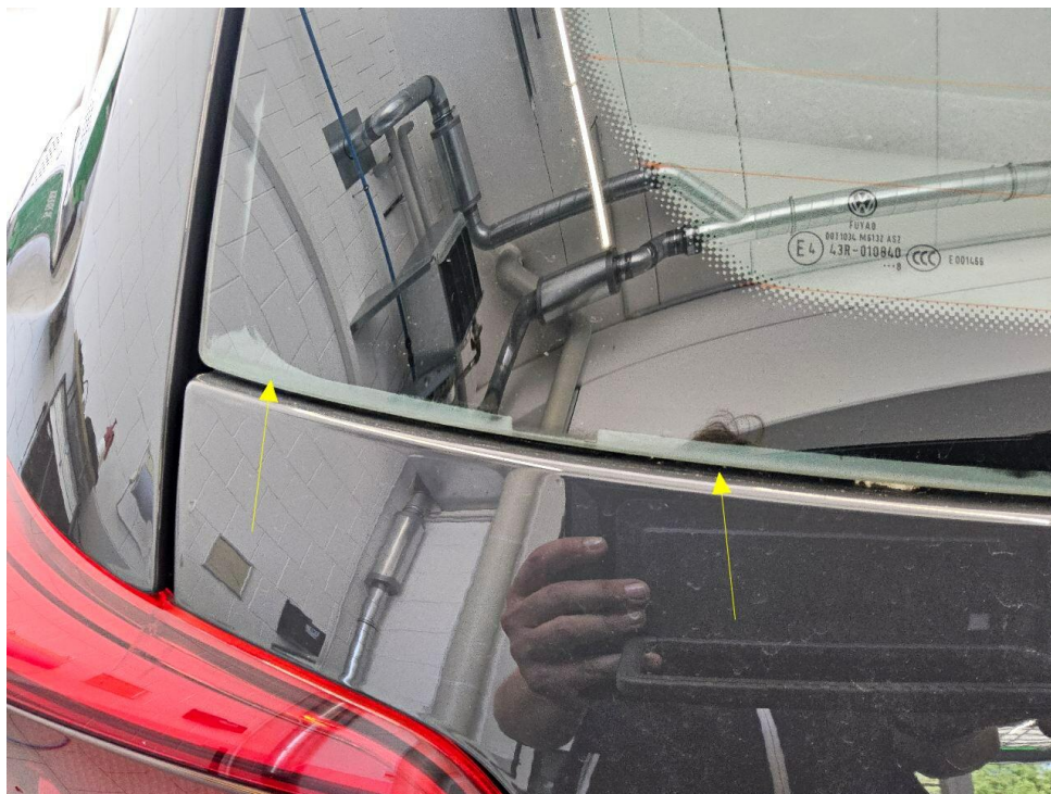
Bild 13 : Heckscheibe, Klebe Erfindung löst sich
