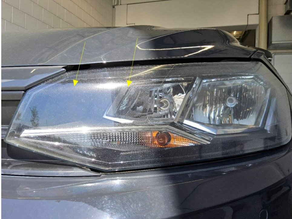
Bild 10 : Hauptscheinwerfer links und rechts, Lichtscheibe matt
