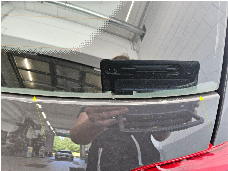
Bild 14 : Heckscheibe, Klebe Erfindung löst sich
