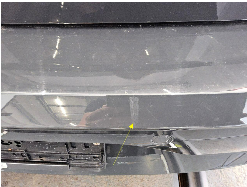
Bild 19 : Diverse Gebrauchsspuren, Kratzer, Dellen und Umweltbeaufschlagung rundum Stoßfänger hinten
