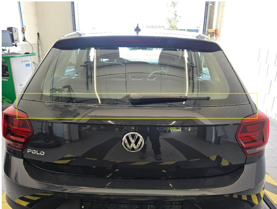
Bild 12 : Heckscheibe, Klebe Erfindung löst sich
