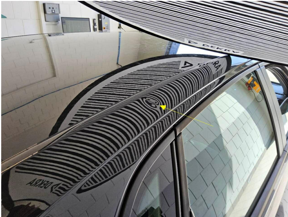
Bild 16 : Diverse Gebrauchsspuren, Kratzer, Dellen und Umweltbeaufschlagung rundum Dachholm rechts
