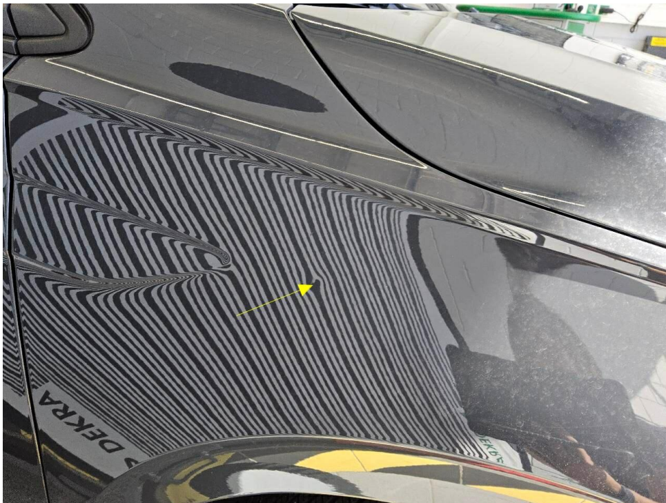
Bild 15 : Diverse Gebrauchsspuren, Kratzer, Dellen und Umweltbeaufschlagung rundum Kotflügel vorne rechts
