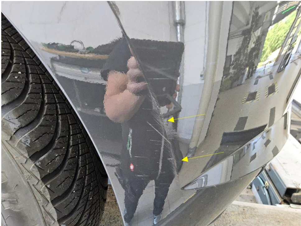
Bild 20 : Diverse Gebrauchsspuren, Kratzer, Dellen und Umweltbeaufschlagung rundum Stoßfänger hinten
