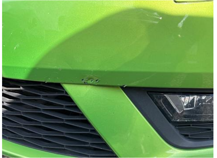
Stoßstange vorne (Kratzer, Lackschaden, Verformung)
