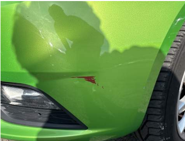
Stoßstange vorne (Kratzer, Lackschaden, Verformung)
