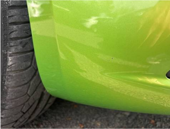
Stoßstange vorne (Kratzer, Lackschaden, Verformung)
