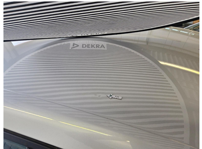
Bild 2: Außen, Dach, mehrfach eingedellt, drücken
