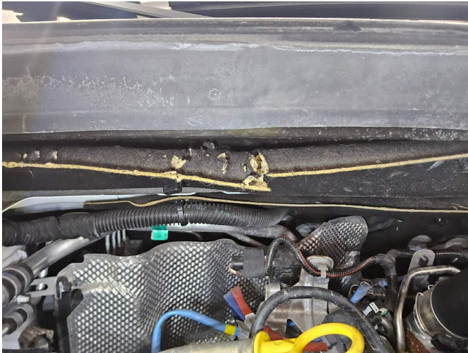
Bild 5: Technik, Dämmmatte Motorraum, Tierverschiss, erneuern
