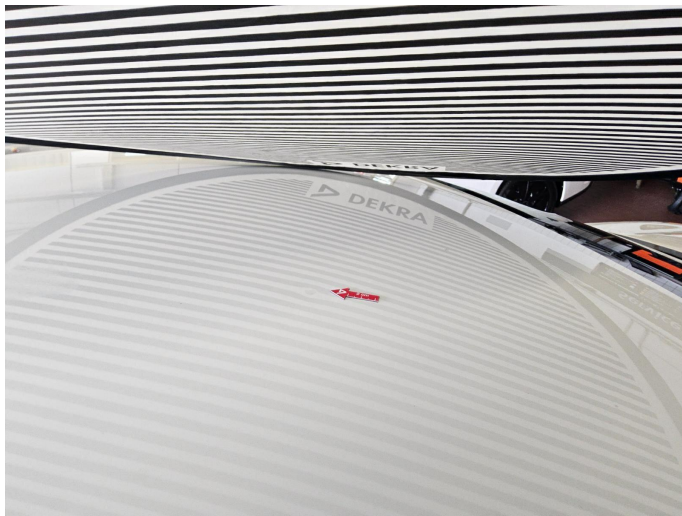
Bild 1: Außen, Dach, mehrfach eingedellt, drücken
