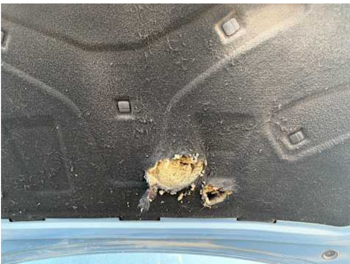
Motorhaube (Anderer Schaden): Dämmmatte beschädigt
