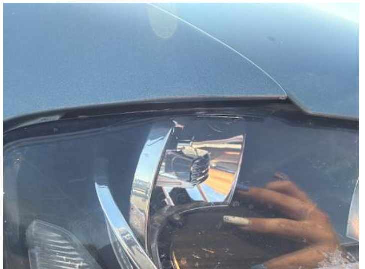
Scheinwerfer (rechts) (Riss/Bruch)
