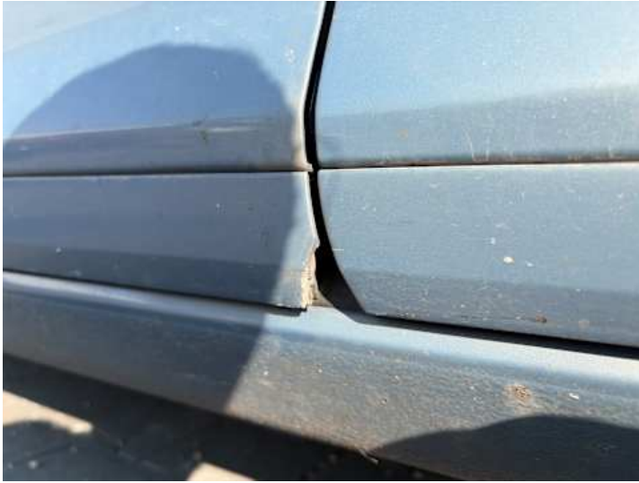
Fahrtür (Riss/Bruch, Spaltmaße ungenau)
