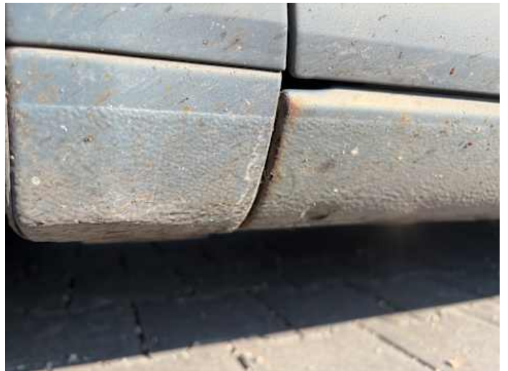
Schweller links (Rost)
