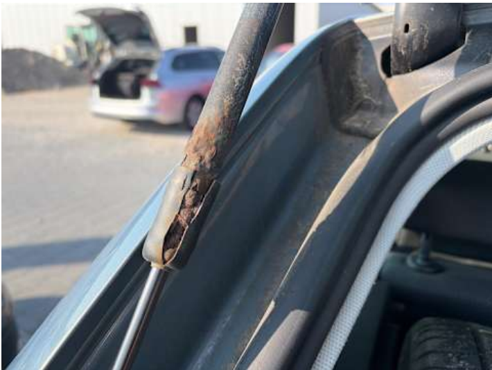
Heckklappe (Anderer Schaden): Dämpfer defekt
