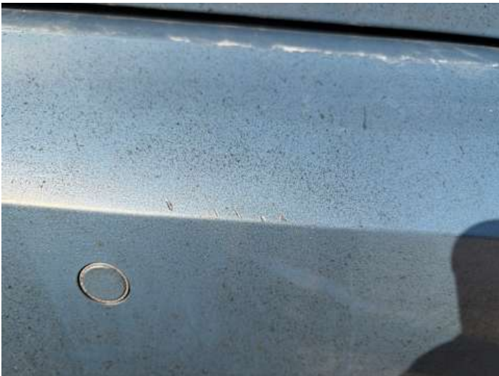
Stoßstange hinten (Lackschaden)
