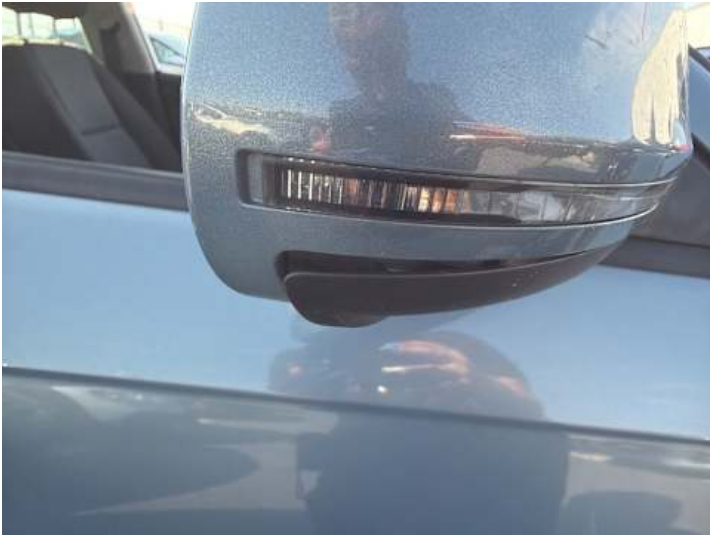
Beifahrtür (Spaltmaße ungenau)
