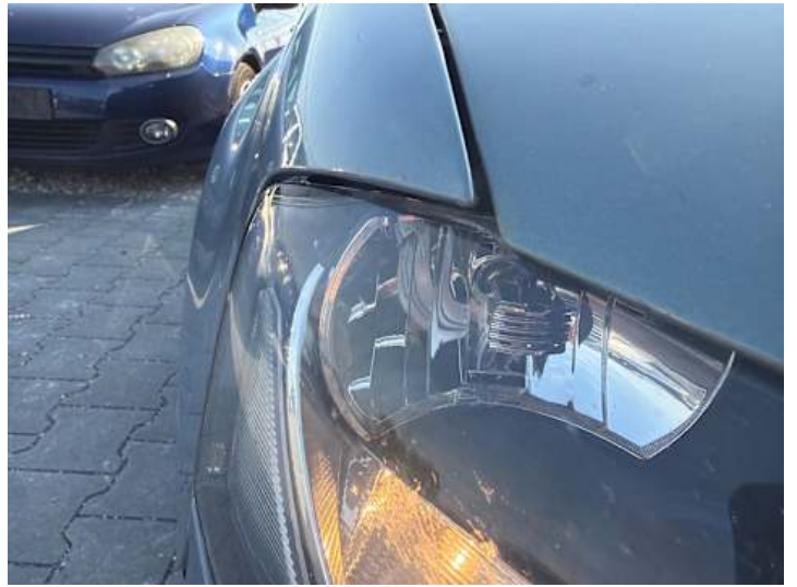
Kotflügel vorne rechts (Spaltmaße ungenau)
