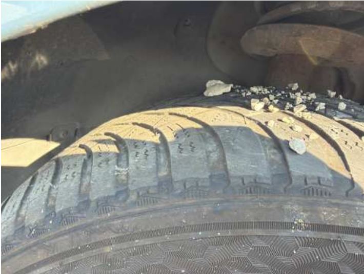
Rad (Ungleichmäßig abgefahren)
