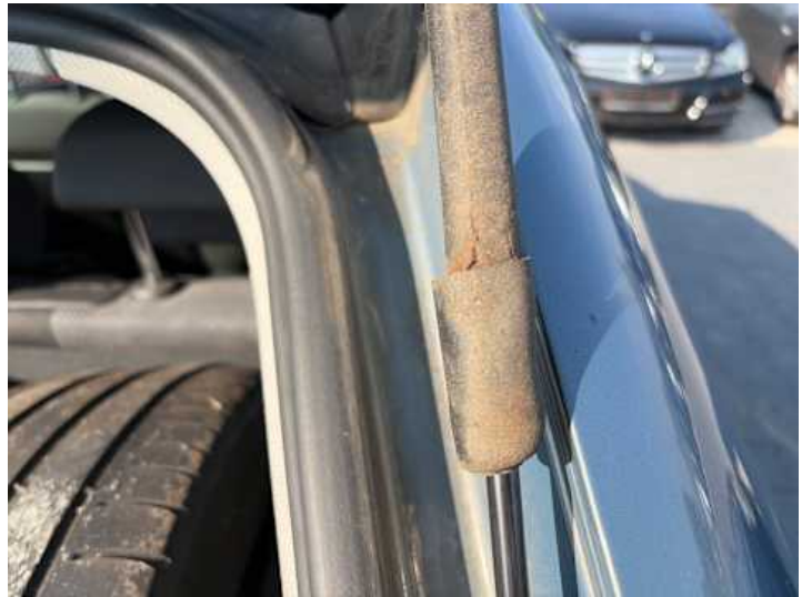
Heckklappe (Anderer Schaden): Dämpfer defekt
