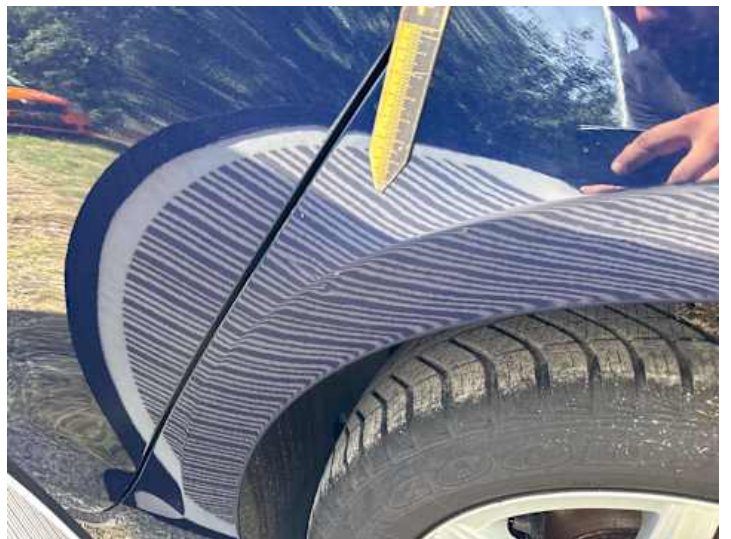
Seitenteil hinten links (Delle, Lackschaden)
