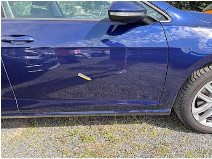
Beifahrertür (Delle, Lackschaden)
