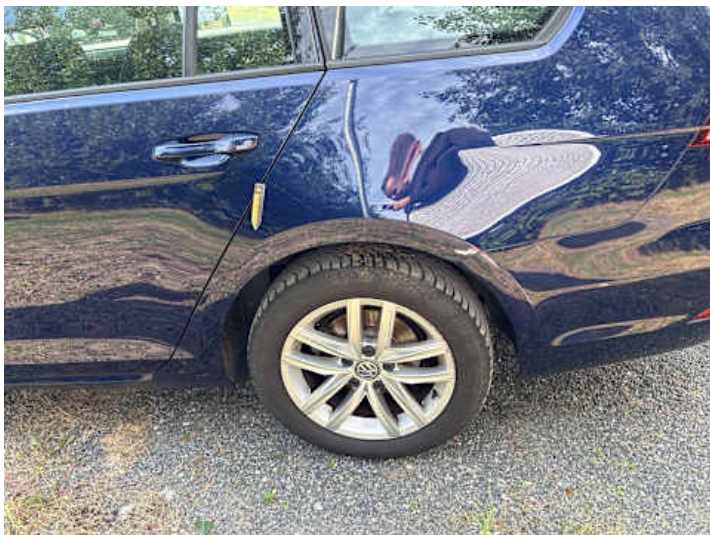
Seitenteil hinten links (Delle, Lackschaden)
