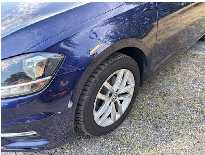
Kotflügel vorne links (Kratzer)
