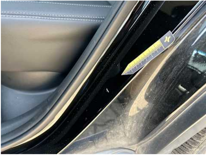
Schweller links (Kratzer)
