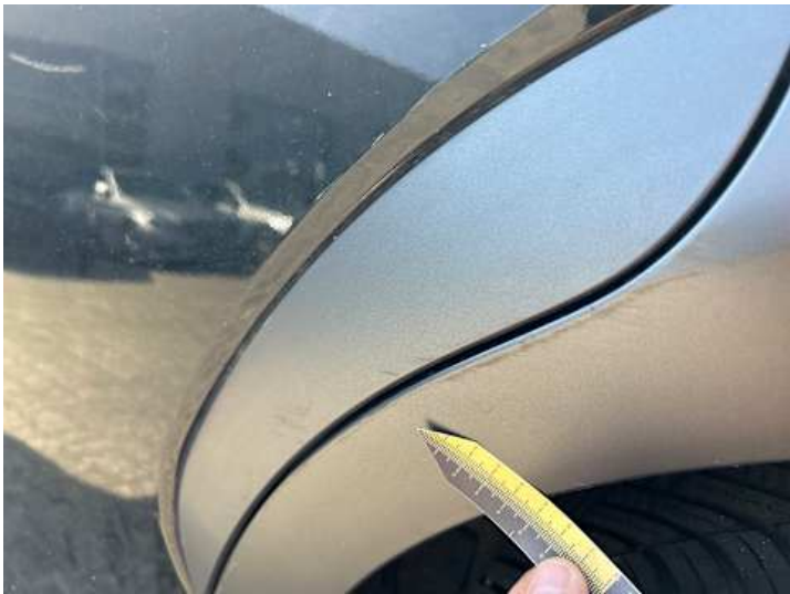
Türe hinten links (Kratzer)
