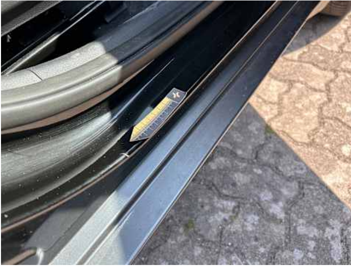
Schweller rechts (Kratzer)
