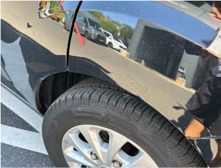
Kotflügel vorne rechts (Verformung)
