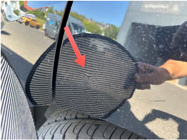
Kotflügel vorne rechts (Verformung)
