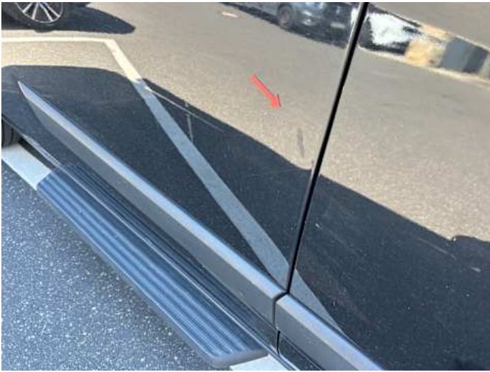
Türe hinten rechts (Kratzer, Unsachgemäß instand gesetzt, Verformung)
