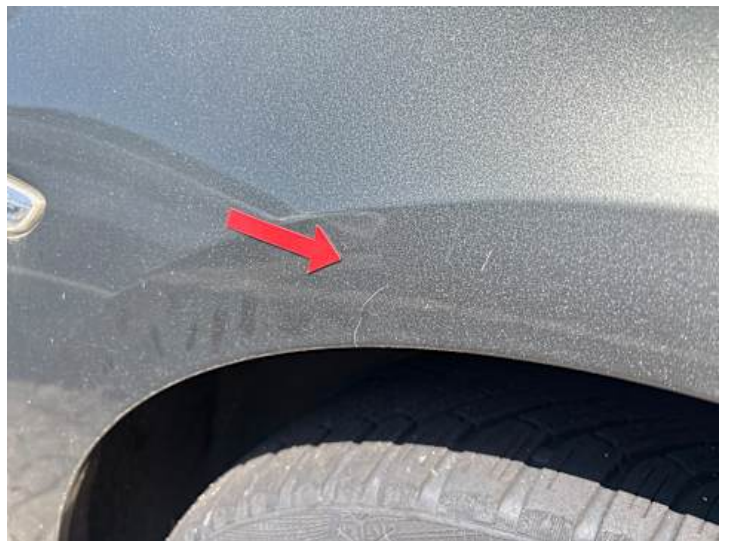
Kotflügel vorne rechts (Kratzer)
