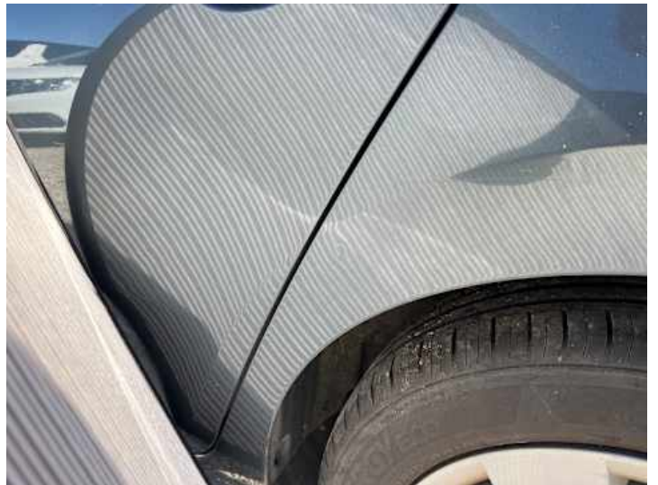
Seitenteil hinten links (Delle)
