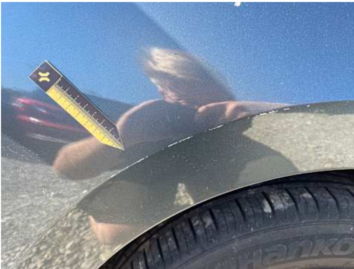
Kotflügel vorne rechts (Kratzer, Lackschaden)
