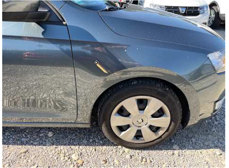
Kotflügel vorne rechts (Kratzer, Lackschaden)
