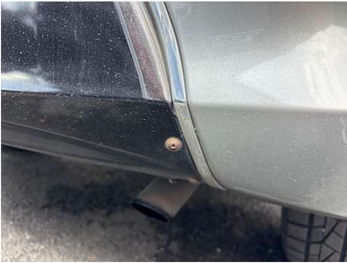
Stoßstange hinten (Unsachgemäß instand gesetzt)
