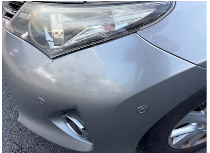
Stoßstange vorne (Unsachgemäß instand gesetzt)
