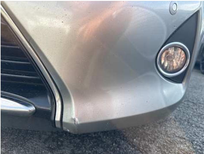
Stoßstange vorne (Steinschlag, Verformung, Kratzer)
