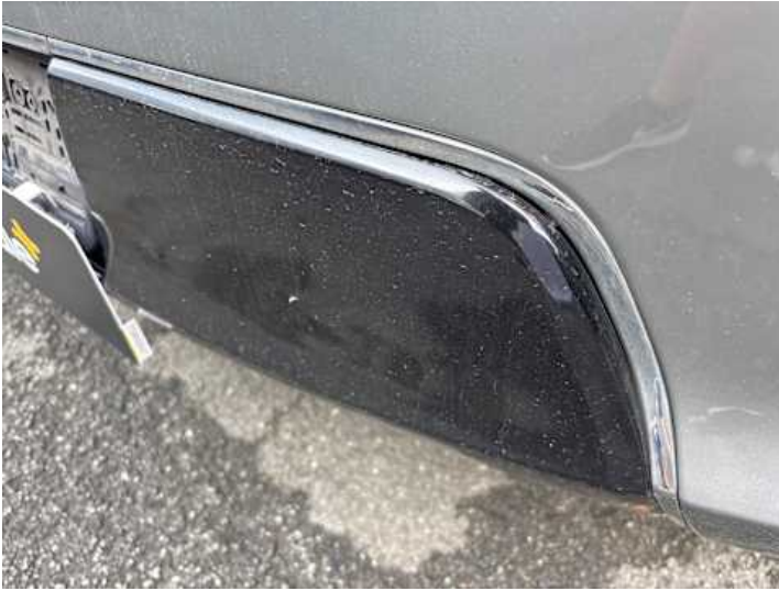
Stoßstange hinten (Verformung, Spaltmaße ungenau)
