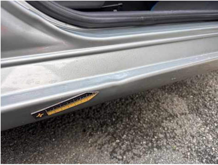
Schweller rechts (Verformung, Delle)
