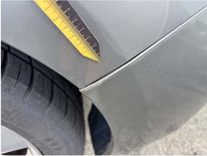
Stoßstange hinten (Lackschaden, Spaltmaße ungenau)
