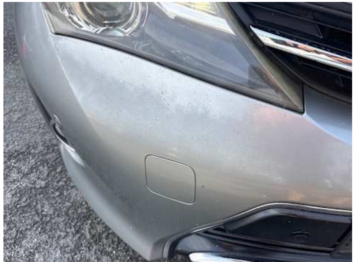
Stoßstange vorne (Unsachgemäß instand gesetzt)
