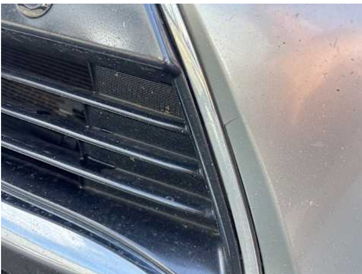
Stoßstange vorne (Riss/Bruch)
