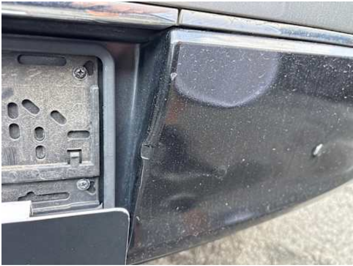
Stoßstange hinten (Verformung, Spaltmaße ungenau)
