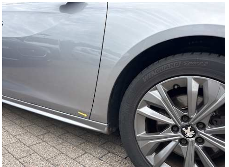
Schweller rechts (Lackschaden, Rost)
