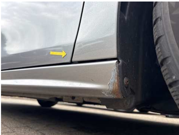
Schweller rechts (Lackschaden, Rost)
