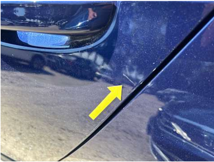
Türe hinten links (Kratzer)
