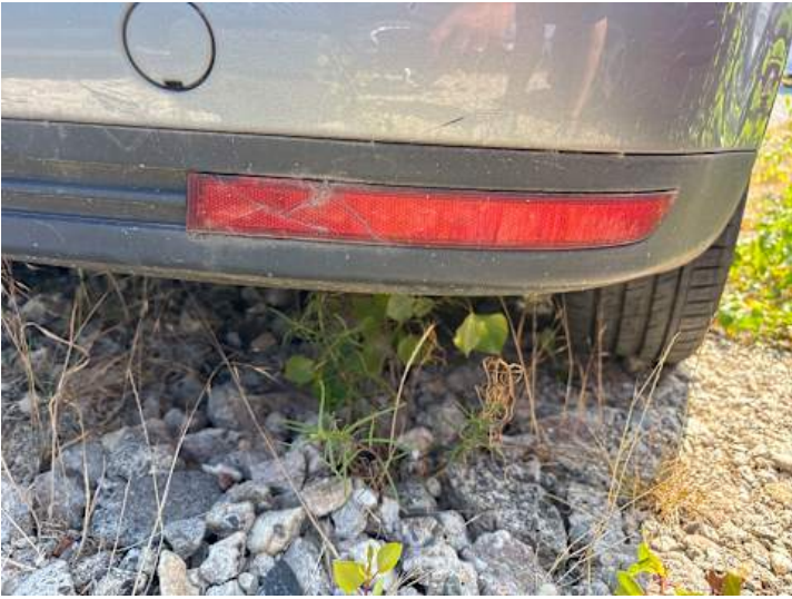
Rücklicht (rechts) (Riss/Bruch)
