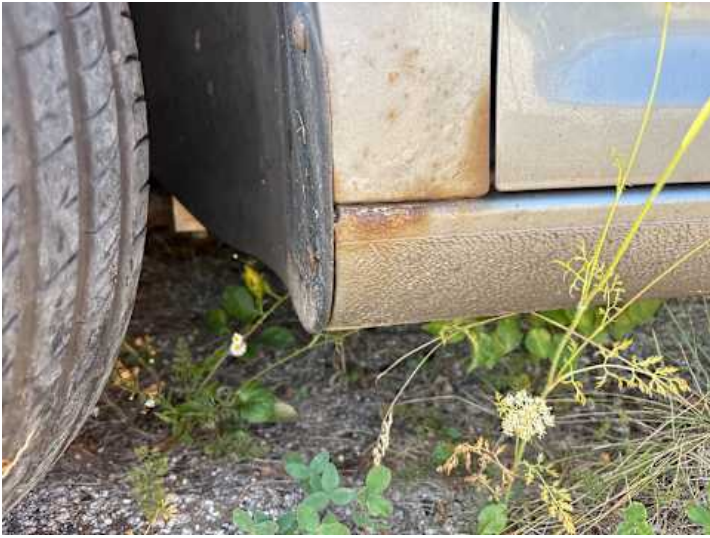
Schweller links (Riss/Bruch)
