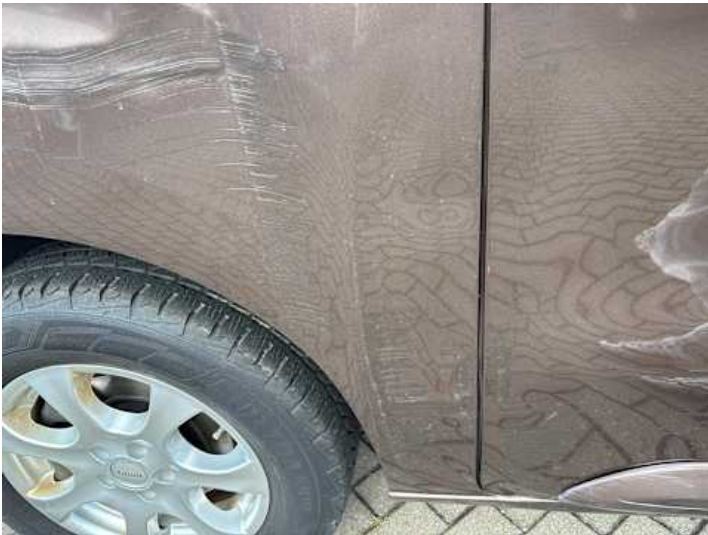
Seitenteil hinten rechts (Verformung, Unsachgemäß instand gesetzt, Kratzer, Lackschaden, Delle, Spaltmaße ungenau)
