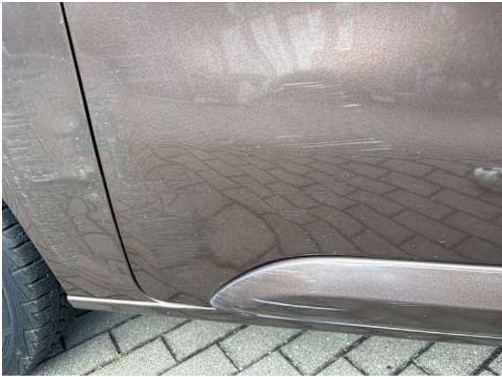
Türe hinten rechts (Kratzer, Lackschaden, Delle, Verformung, Spaltmaße ungenau, Unsachgemäß instand gesetzt)
