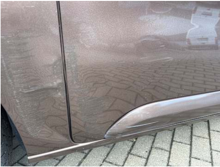
Türe hinten rechts (Kratzer, Lackschaden, Delle, Verformung, Spaltmaße ungenau, Unsachgemäß instand gesetzt)
