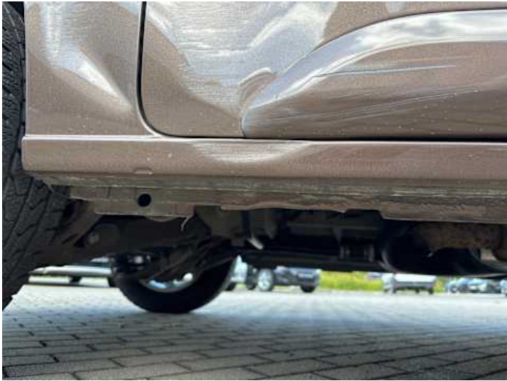
Schweller rechts (Kratzer, Lackschaden, Verformung, Spaltmaße ungenau)
