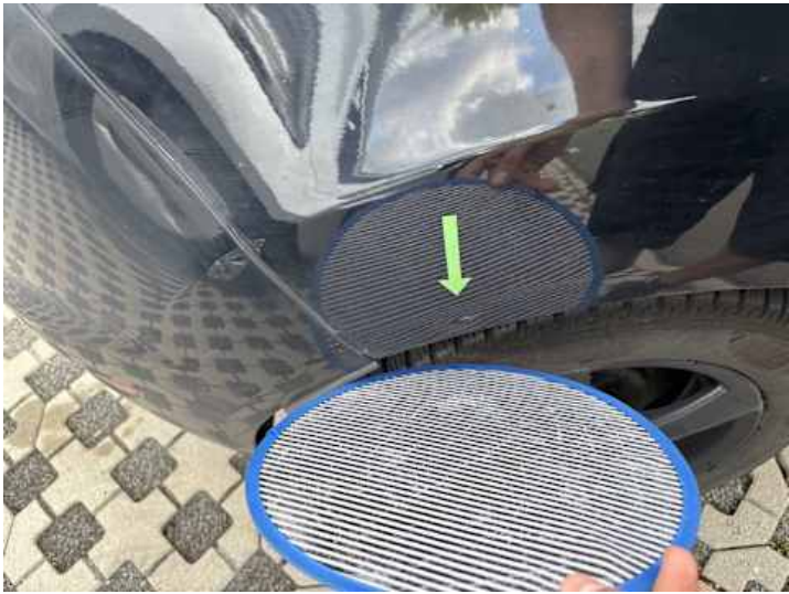
Seitenteil hinten rechts (Delle)
