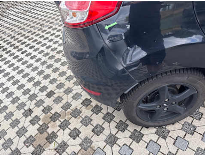
Stoßstange hinten (Spaltmaße ungenau)
