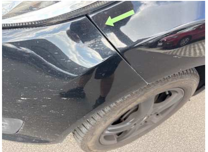
Stoßstange vorne (Spaltmaße ungenau)
