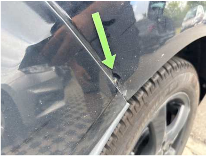
Seitenteil hinten rechts (Lackschaden)
