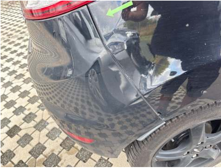
Stoßstange hinten (Spaltmaße ungenau)
