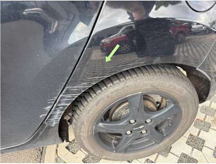
Seitenteil hinten links (Lackschaden, Verformung)
