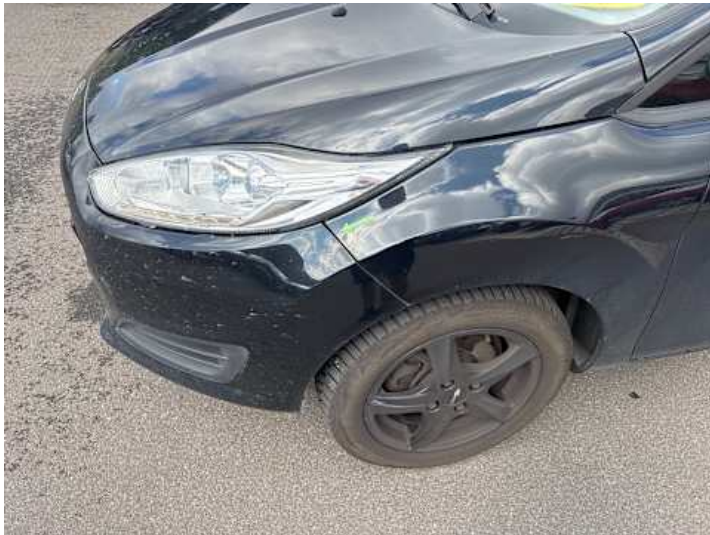
Stoßstange vorne (Spaltmaße ungenau)
