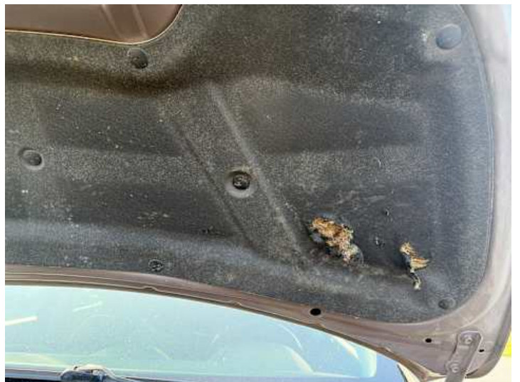
Motorhaube (Anderer Schaden): Dämmmatte beschädigt
