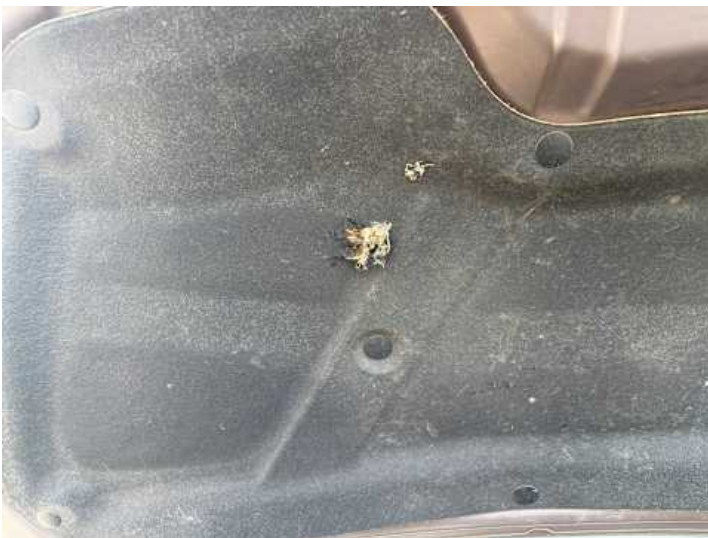
Motorhaube (Anderer Schaden): Dämmmatte beschädigt
