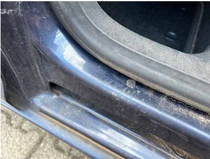
Schweller links (Kratzer)
