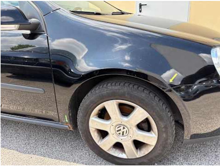
Kotflügel vorne rechts (Delle, Kratzer)
