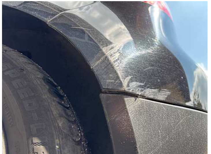
Stoßstange hinten (Spaltmaße ungenau)
