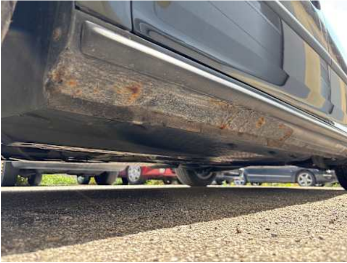
Schweller links (Unsachgemäß instand gesetzt, Rost)
