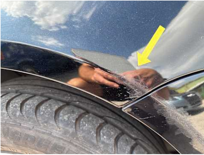
Kotflügel vorne rechts (Delle, Kratzer)
