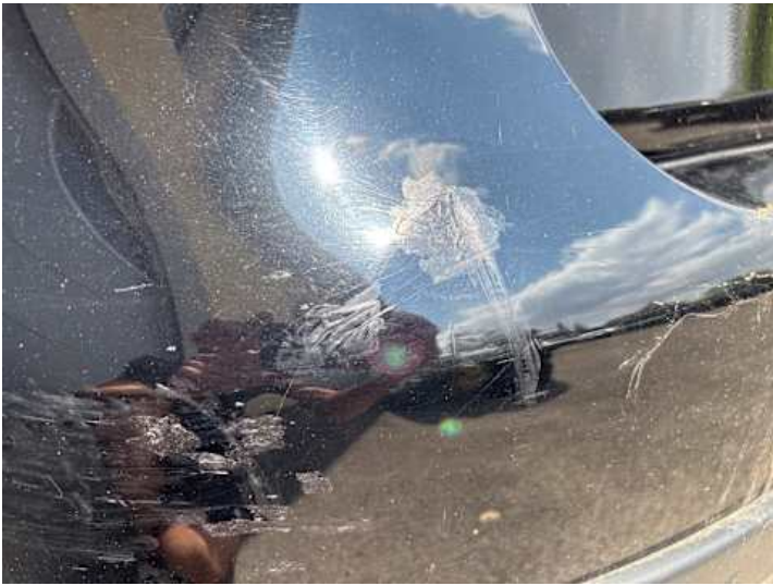
Stoßstange hinten (Riss/Bruch)
