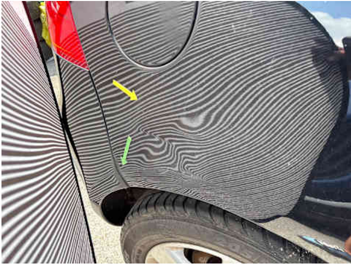
Seitenteil hinten rechts (Verformung, Lackschaden)
