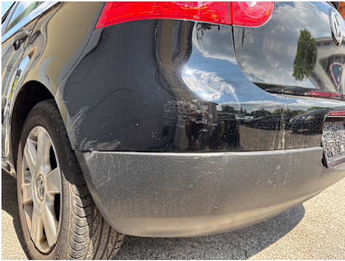
Stoßstange hinten (Riss/Bruch)
