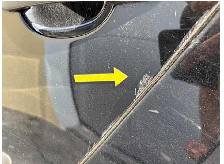
Türe hinten links (Lackschaden)
