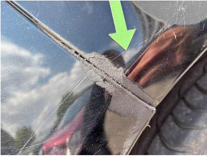
Seitenteil hinten rechts (Verformung, Lackschaden)
