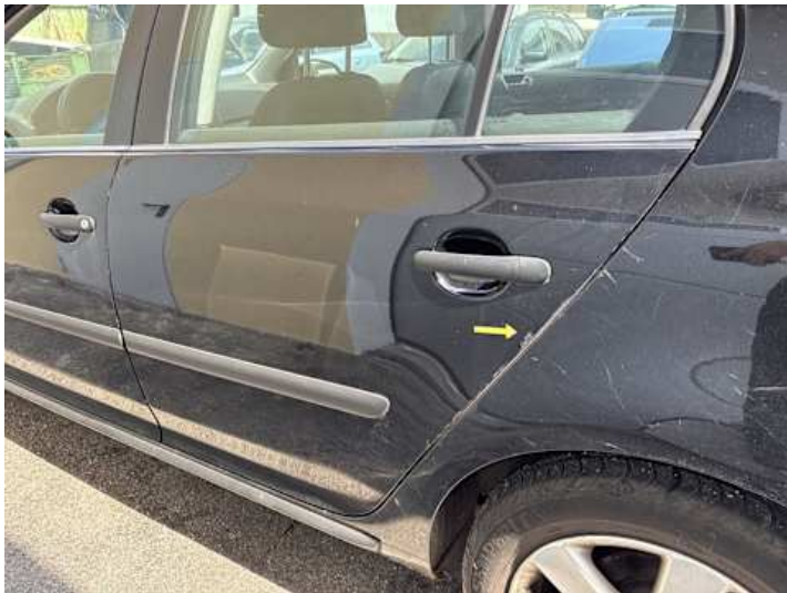
Türe hinten links (Lackschaden)
