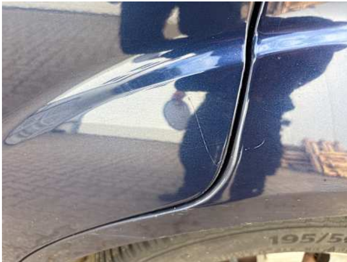
Türe hinten links (Kratzer)
