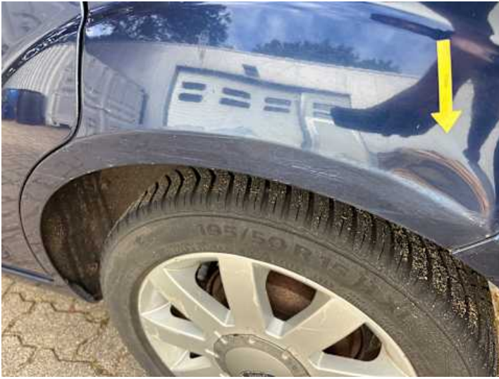
Seitenteil hinten links (Verformung, Kratzer)
