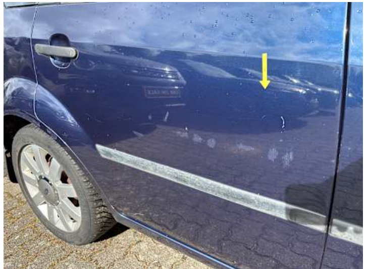
Türe hinten rechts (Kratzer, Lackschaden)
