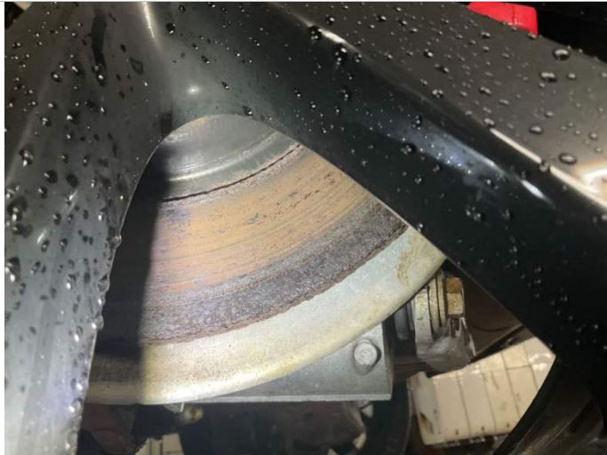
Bremsscheiben Hinterachse Rostrand
