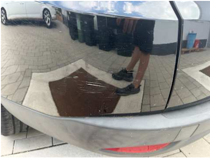
Stoßstange hinten (Lackschaden, Kratzer)
