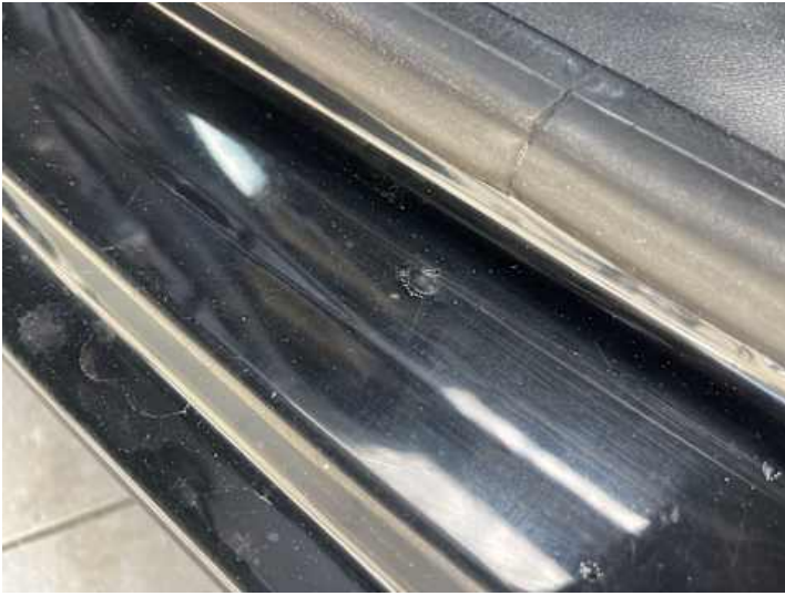
Schweller links (Rost)
