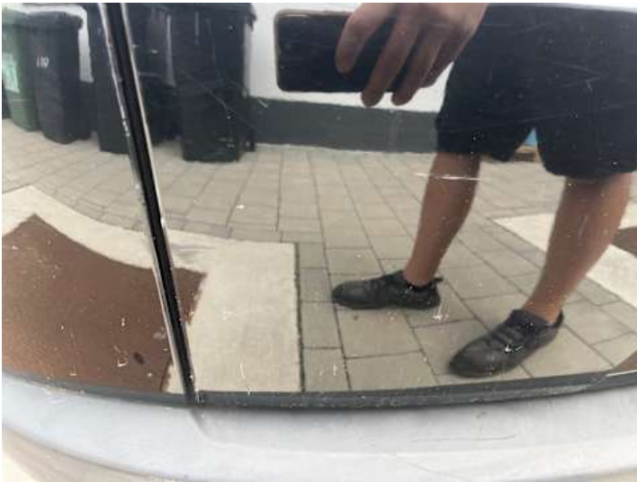
Heckklappe (Lackschaden, Kratzer)
