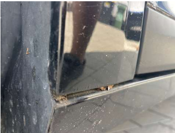
Kotflügel vorne links (Rost)
