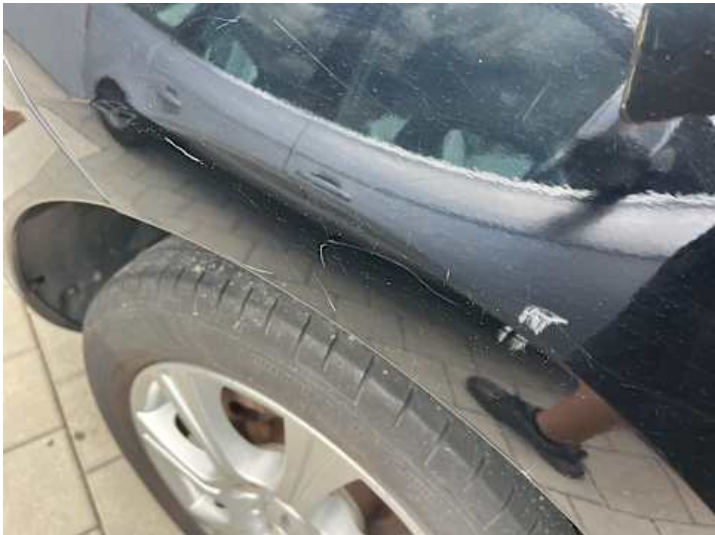
Seitenteil hinten rechts (Lackschaden, Kratzer)
