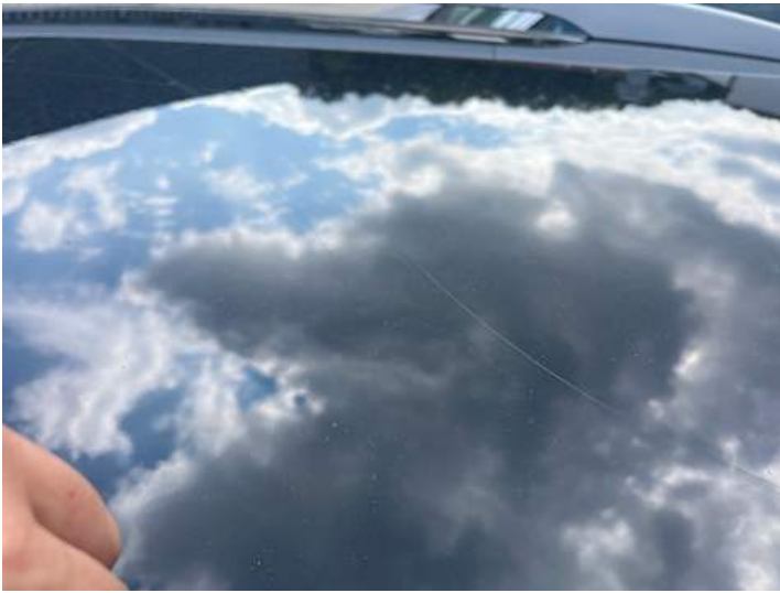
Dach (Lackschaden, Kratzer)
