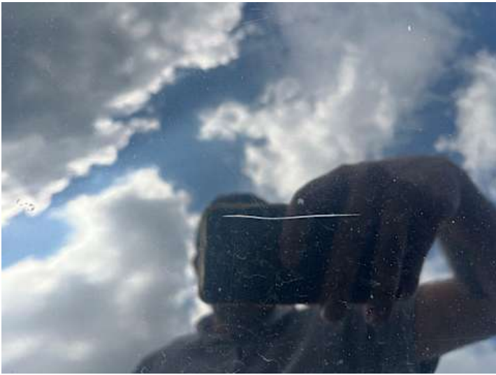
Motorhaube (Lackschaden, Kratzer)
