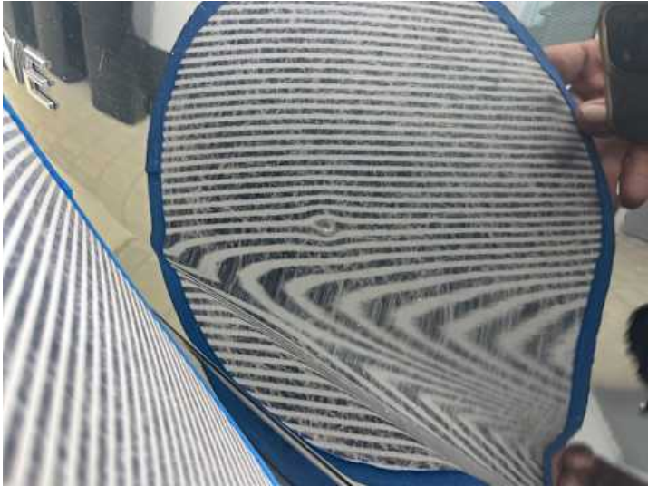
Heckklappe (Delle, Lackschaden)
