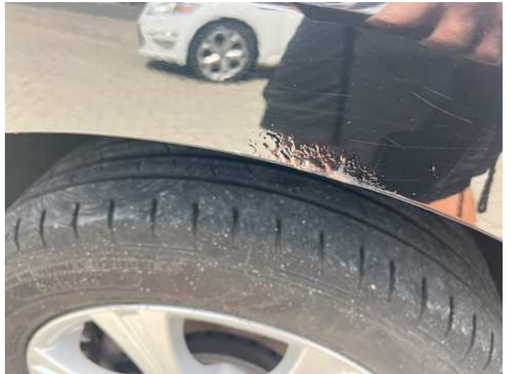
Kotflügel vorne links (Rost)
