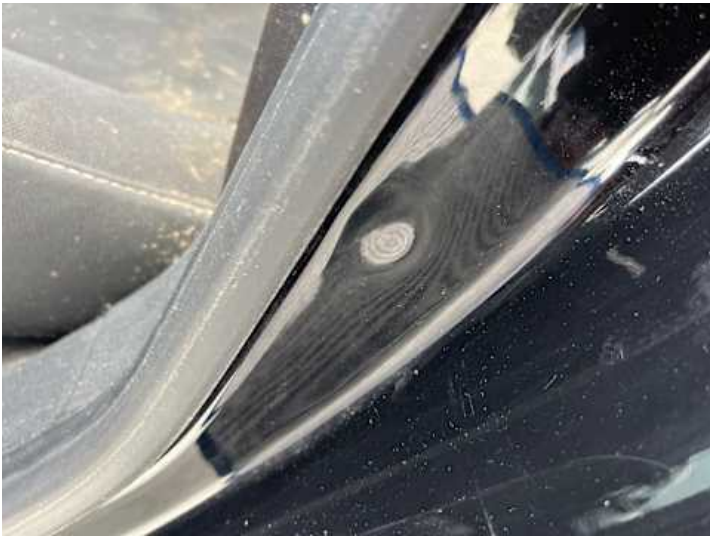
Seitenteil hinten links (Delle)
