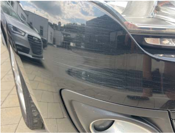
Stoßstange vorne (Kratzer, Lackschaden)
