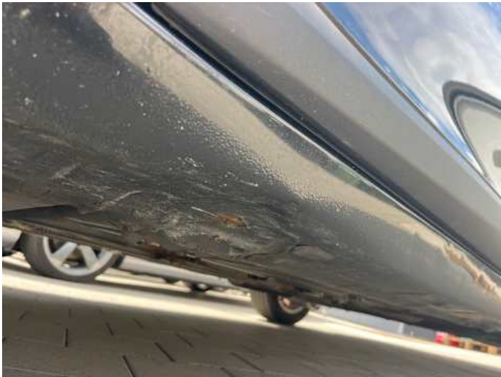
Schweller links (Verformung)
