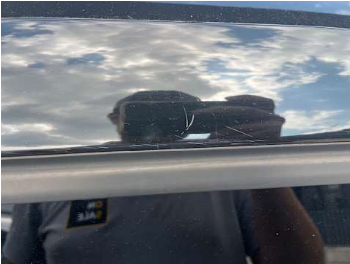
Seitenteil hinten rechts (Lackschaden, Kratzer)
