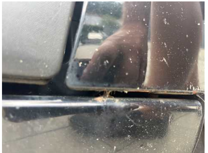
Kotflügel vorne rechts (Rost)
