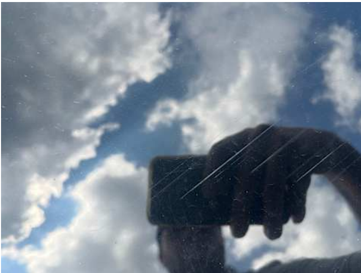
Motorhaube (Lackschaden, Kratzer)
