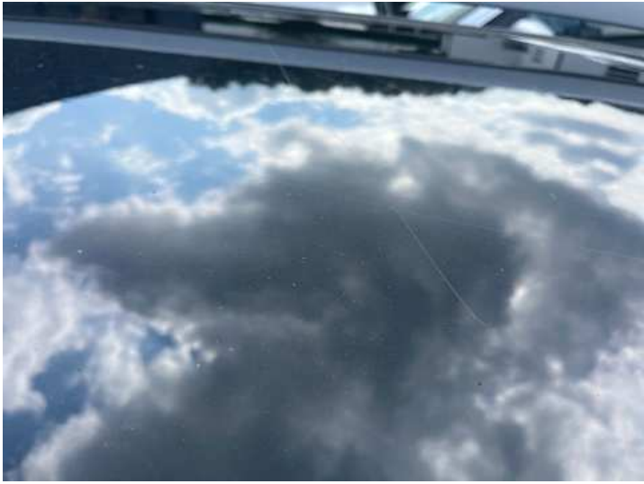
Dach (Lackschaden, Kratzer)
