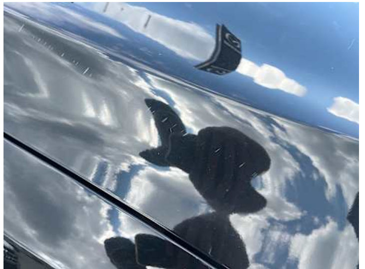
Motorhaube (Lackschaden, Kratzer)
