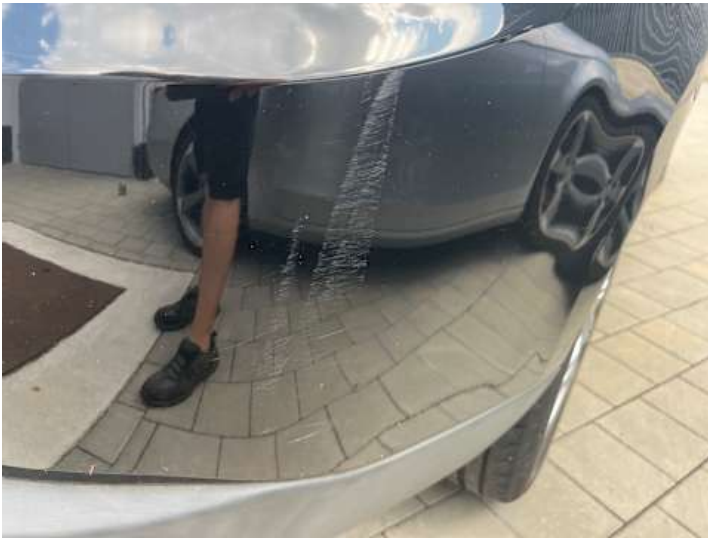
Stoßstange hinten (Lackschaden, Kratzer)
