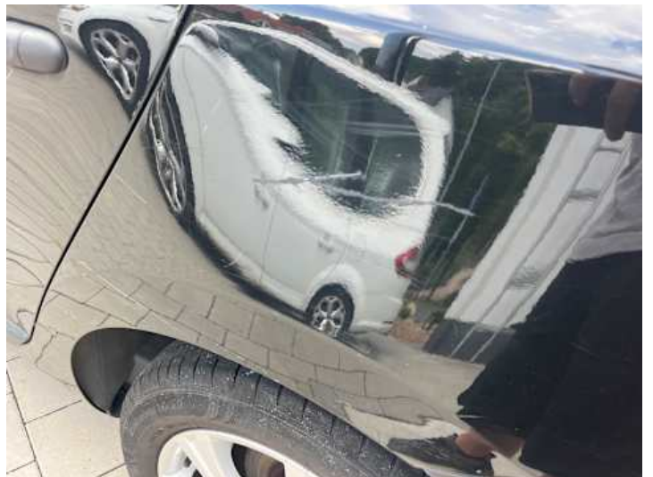
Seitenteil hinten rechts (Lackschaden, Kratzer, Unsachgemäß instand gesetzt)
