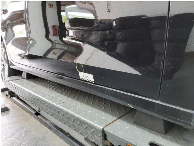
Tür vorne rechts, eingedellt, drücken (DEKRA)
