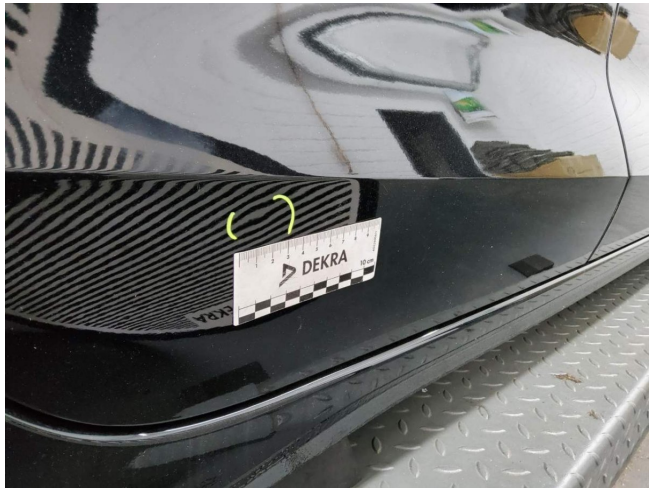
Tür hinten rechts, eingedellt, Gebrauchsspur (DEKRA)
