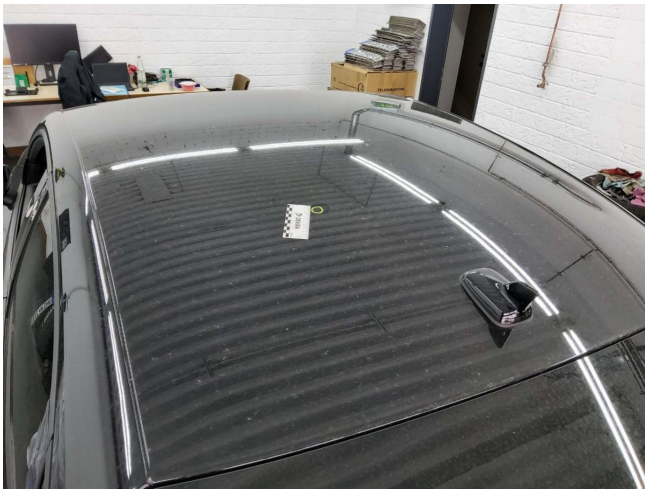
Dach, eingedellt, drücken (DEKRA)
