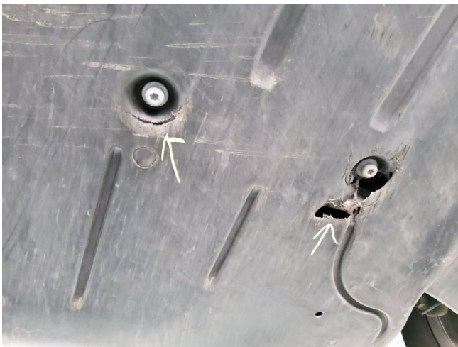
Motorabdeckung unten beschädigt (DEKRA)
