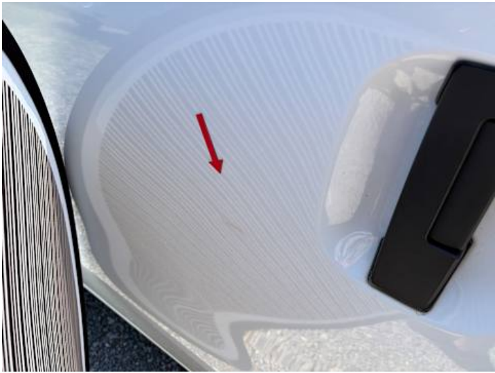
Türe hinten rechts (Kratzer, Lackschaden, Delle)
