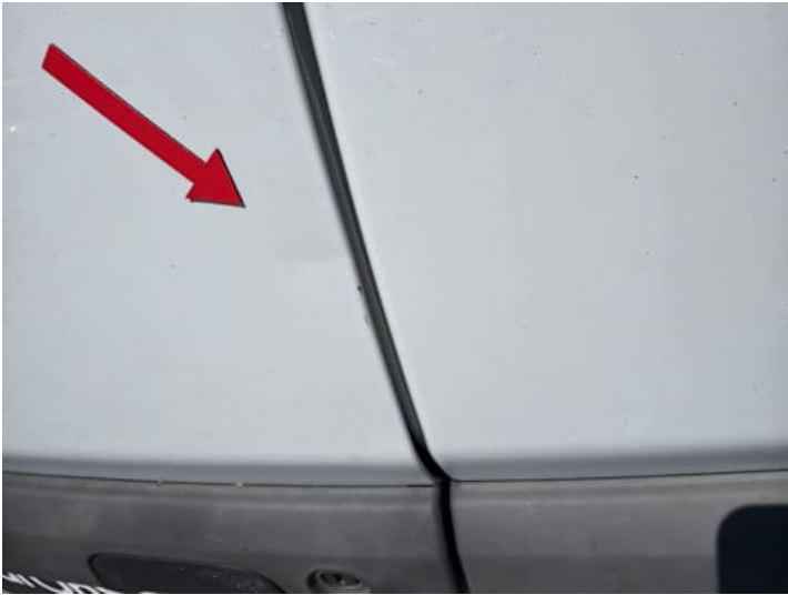
Heckklappe (Lackschaden, Delle)
