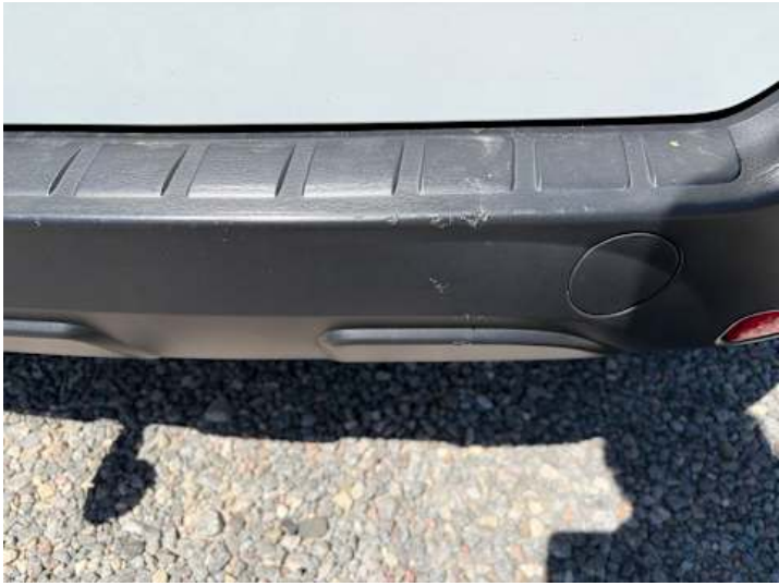
Stoßstange hinten (Kratzer, Verformung)
