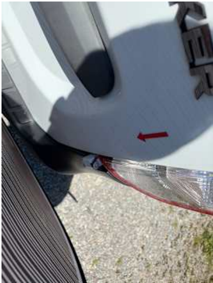
Heckklappe (Lackschaden, Delle)
