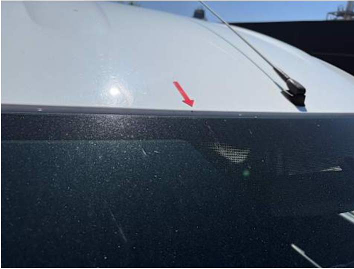
Dach (Steinschlag, Lackschaden)
