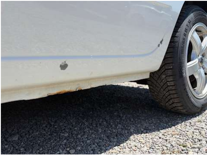
Schweller links (Rost)
