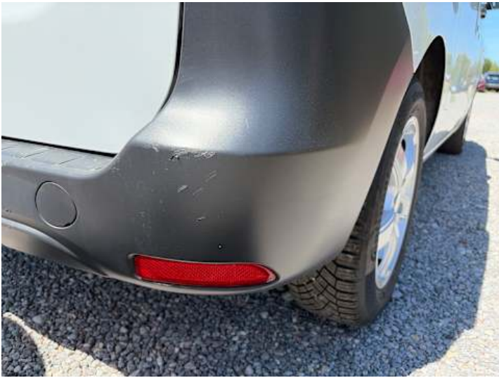
Stoßstange hinten (Kratzer, Verformung)
