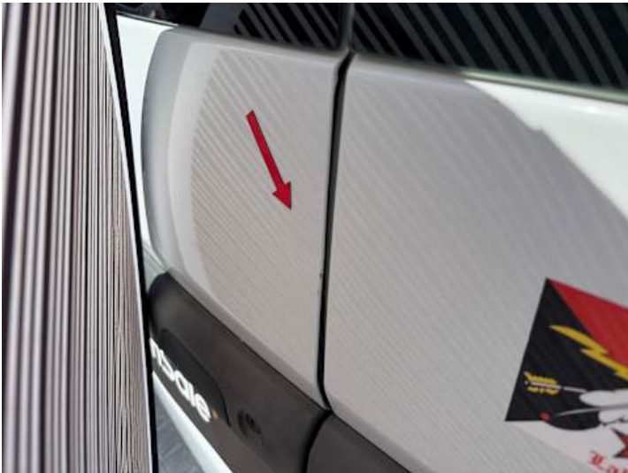
Heckklappe (Lackschaden, Delle)
