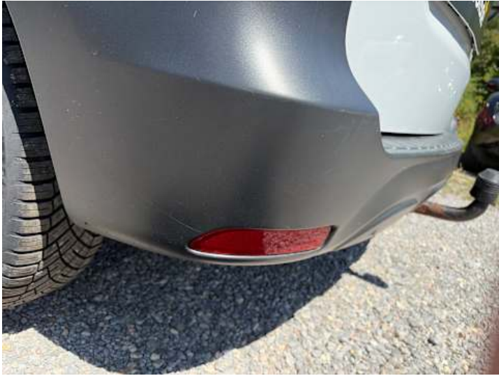
Stoßstange hinten (Kratzer, Verformung)
