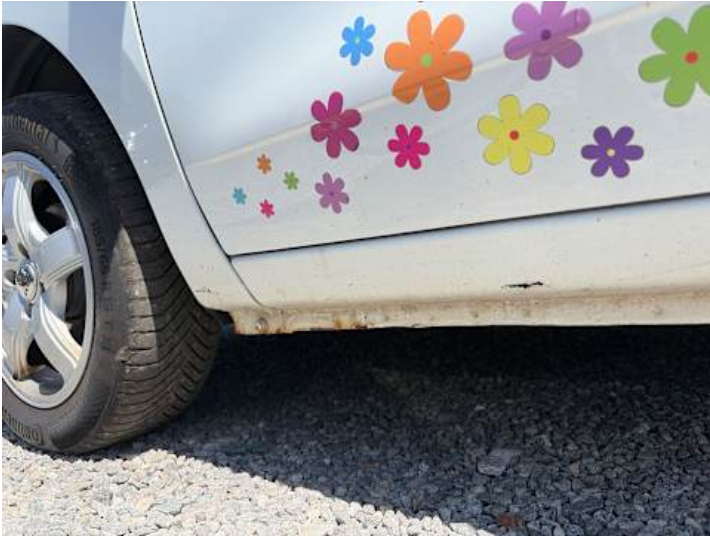
Schweller links (Rost)
