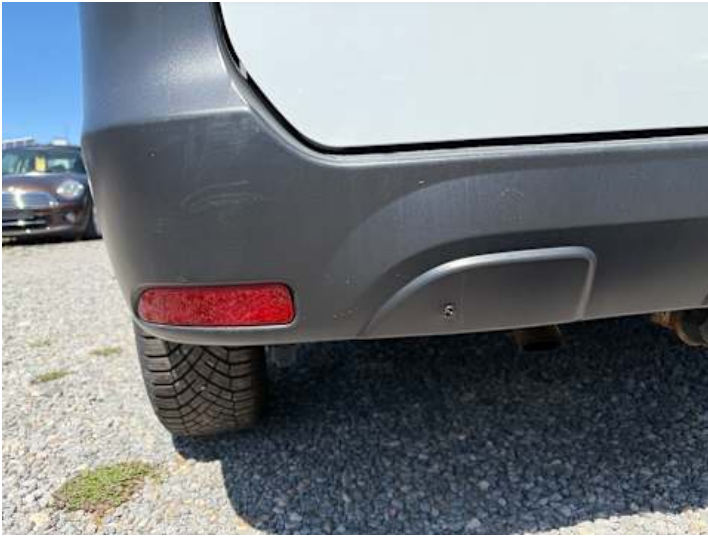
Stoßstange hinten (Kratzer, Verformung)
