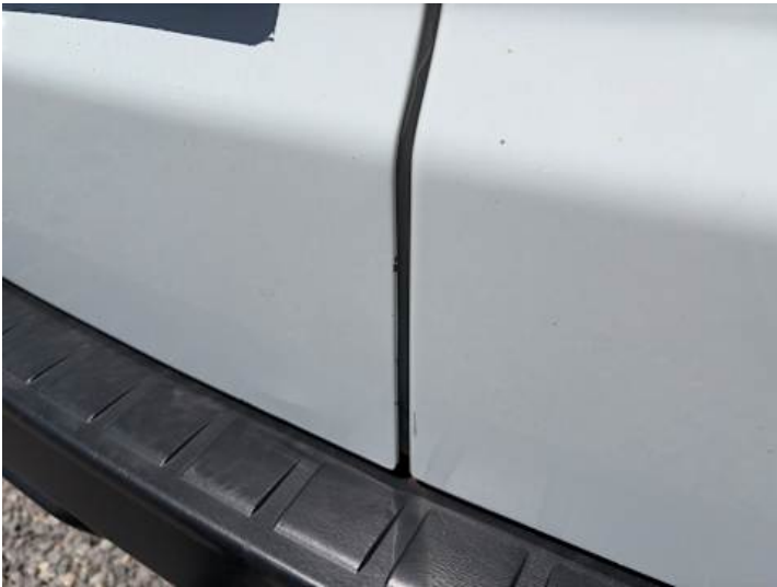
Heckklappe (Lackschaden, Delle)
