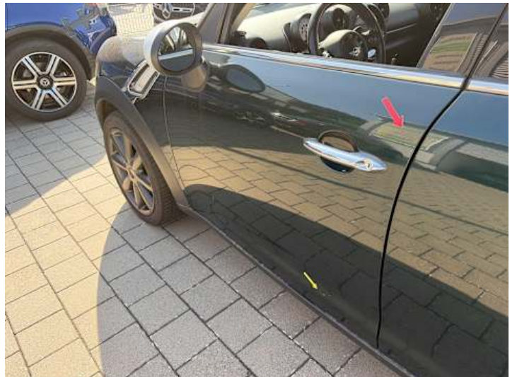
Fahrtür (Kratzer, Delle)
