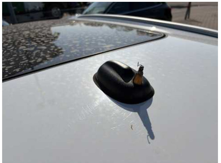
Dach (Riss/Bruch, Anderer Schaden): Antenne
