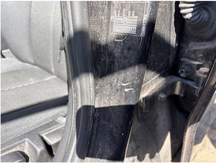
Schweller links (Kratzer, Delle)
