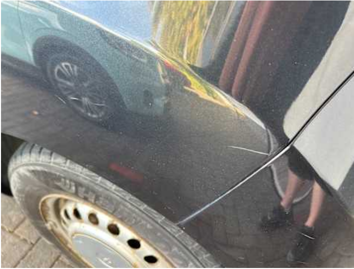
Seitenteil hinten links (Kratzer)
