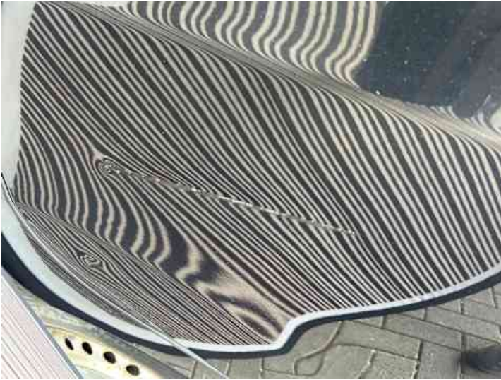
Türe hinten rechts (Verformung, Kratzer)
