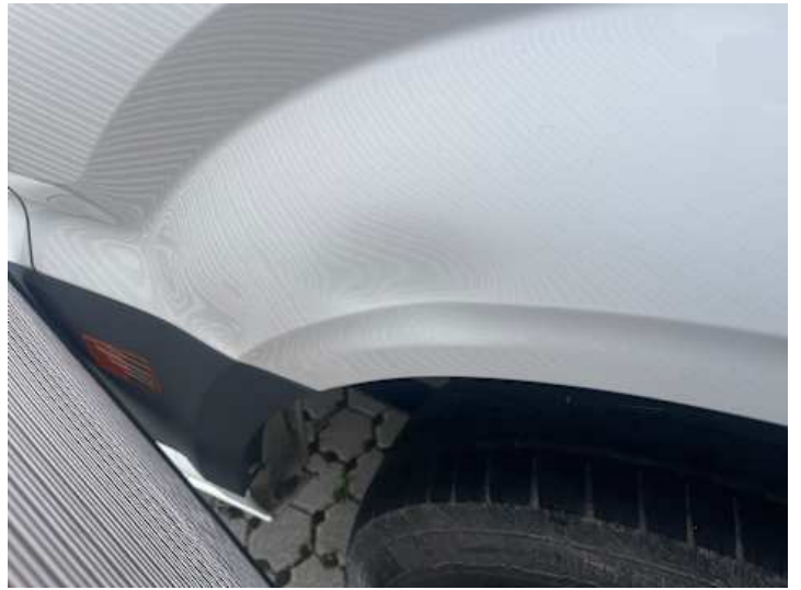
Seitenteil hinten links (Verformung)
