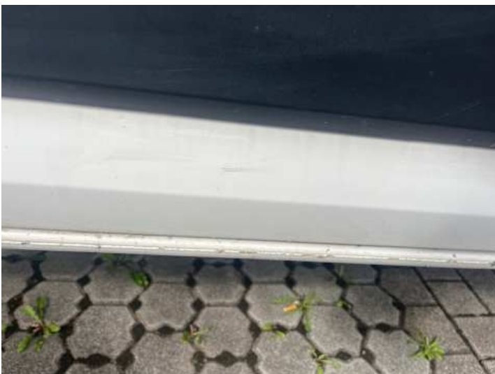
Türe hinten rechts (Kratzer, Lackschaden)
