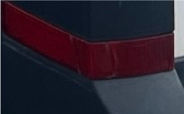
Stoßstange hinten (Riss/Bruch)
