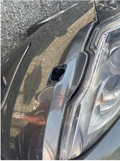
Stoßstange vorne (Riss/Bruch)
