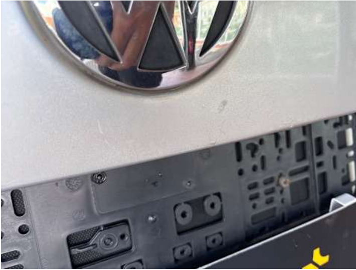
Heckklappe (Kratzer, Rost)
