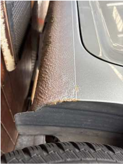
Schweller links (Rost)
