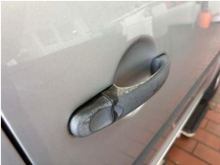
Beifahrtür (Riss/Bruch, Ausgeblichen/Matt)
