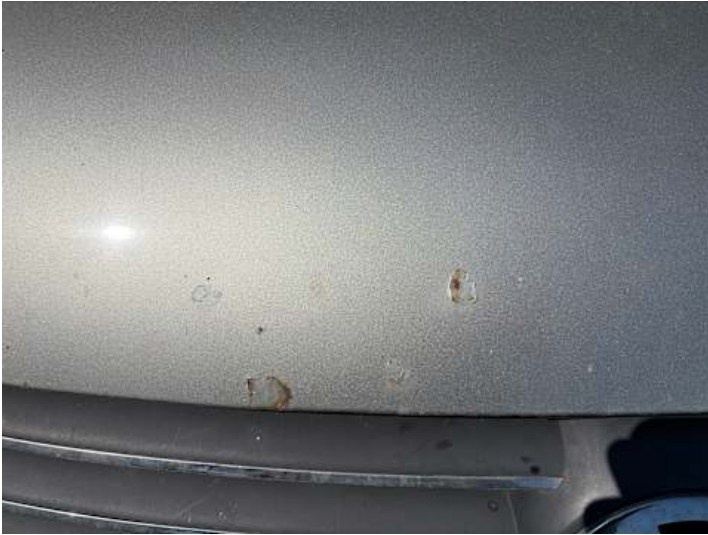
Motorhaube (Lackschaden, Steinschlag, Rost)
