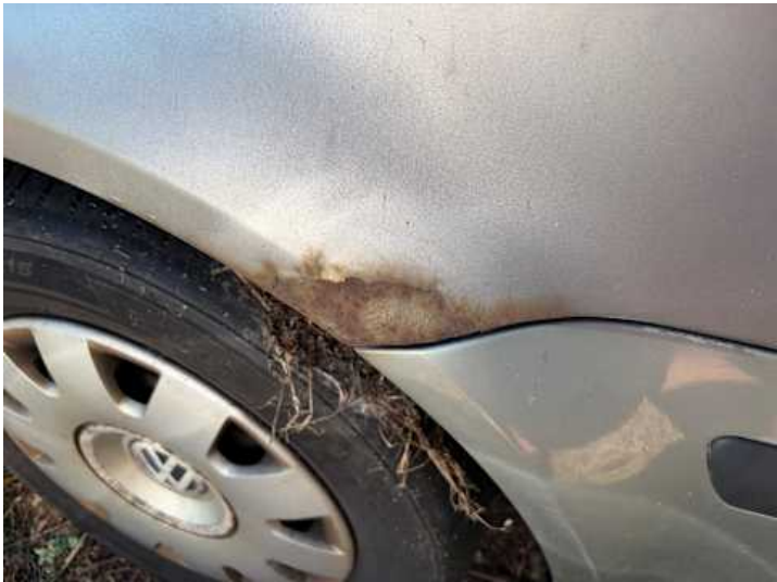
Seitenteil hinten links (Rost, Lackschaden)
