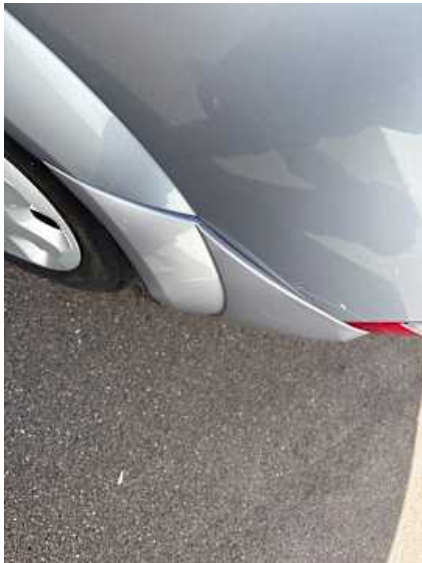
Stoßstange hinten (Verformung, Spaltmaße ungenau)
