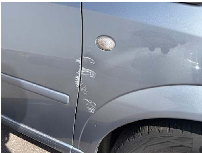
Kotflügel vorne rechts (Verformung, Lackschaden)
