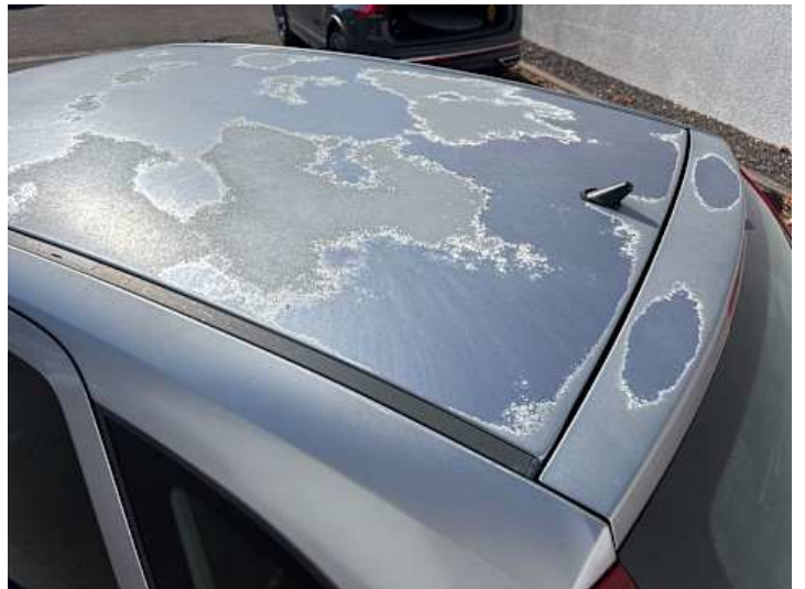
Dach (Ausgeblichen/Matt, Lackschaden)
