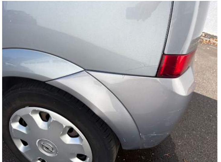
Stoßstange hinten (Verformung, Spaltmaße ungenau)
