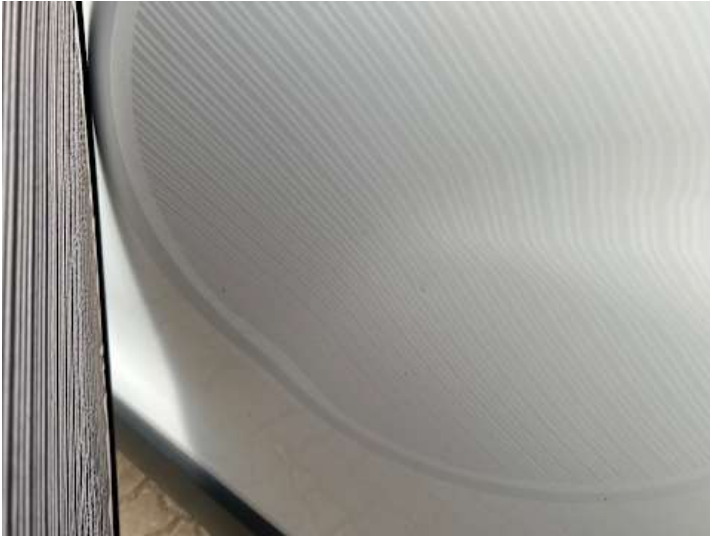
Türe hinten links (Delle)
