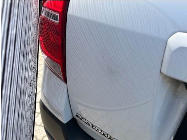
Heckklappe (Delle, Kratzer)
