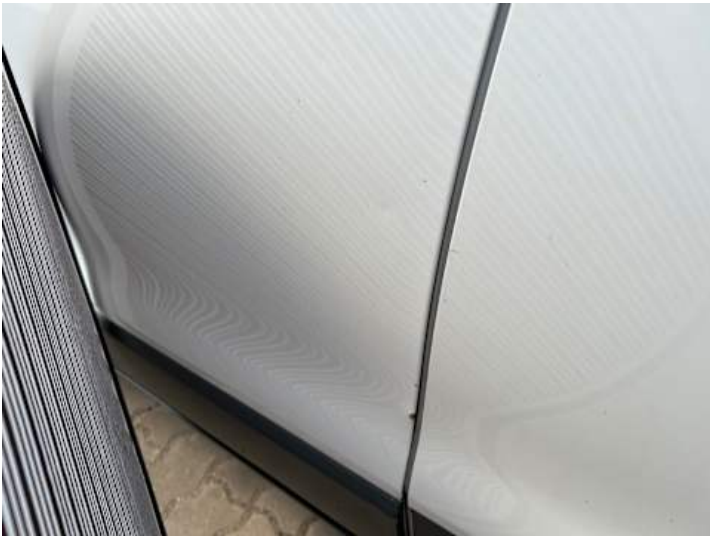
Fahrertür (Verformung, Delle, Lackschaden)
