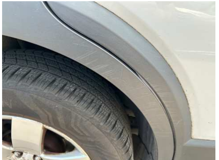
Seitenteil hinten rechts (Riss/Bruch, Kratzer)
