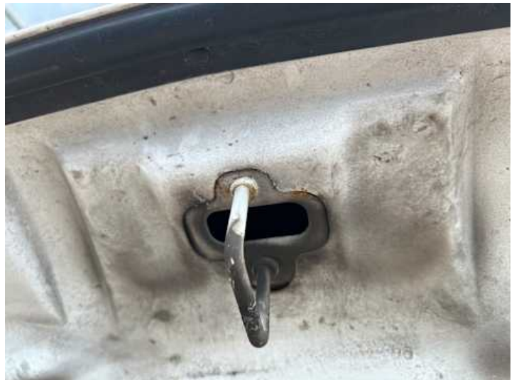
Motorhaube (Rost, Delle)
