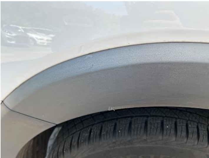
Seitenteil hinten rechts (Riss/Bruch, Kratzer)
