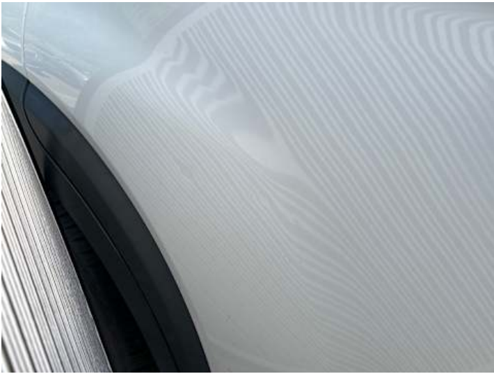
Türe hinten rechts (Delle, Kratzer)
