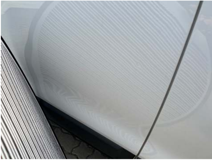
Türe hinten rechts (Delle, Kratzer)
