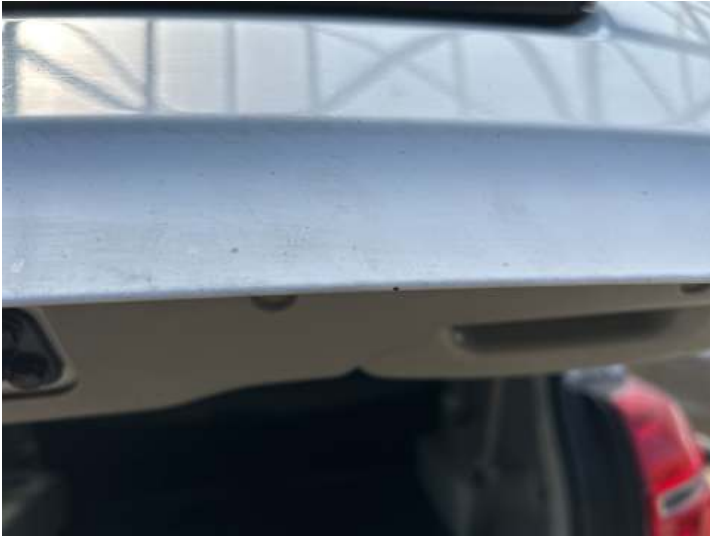
Heckklappe (Delle, Kratzer)
