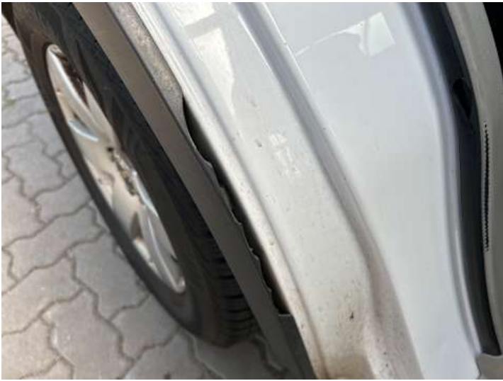
Seitenteil hinten rechts (Riss/Bruch, Kratzer)
