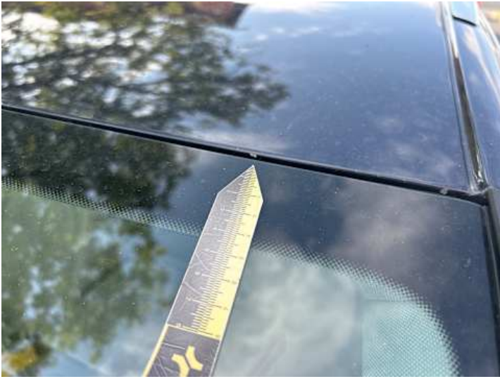
Dach (Lackschaden, Steinschlag)
