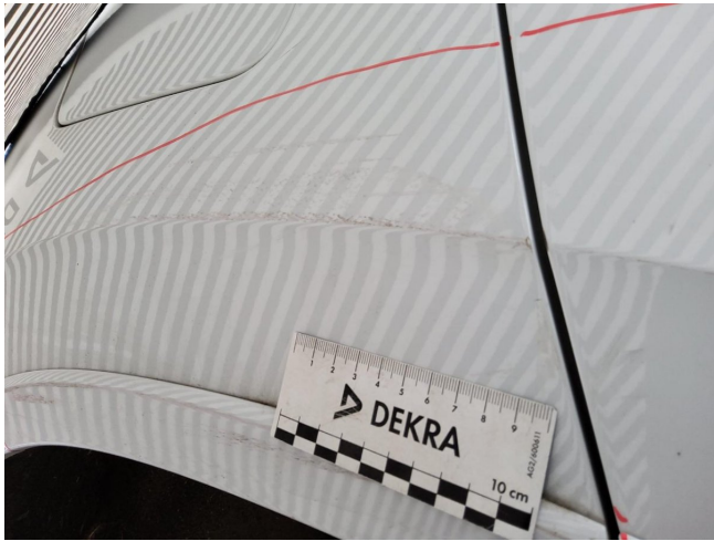
Seitenteil hinten rechts, deformiert, instandsetzen und lackieren mit Lackaufbau (DEKRA)
