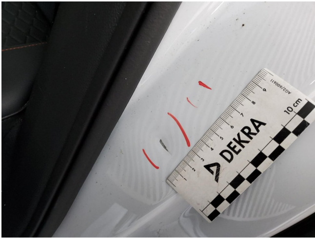
Tür hinten links Einstieg Lackierung, verschrammt, smart repair (DEKRA)
