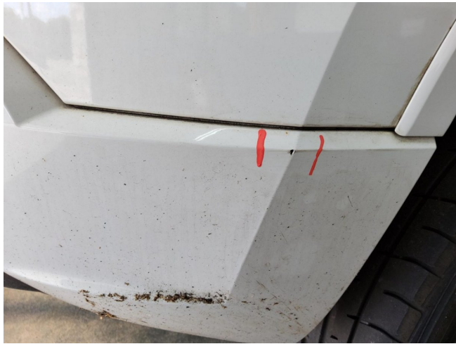
Stoßfänger hinten Lackierung, verschrammt, smart repair (DEKRA)
