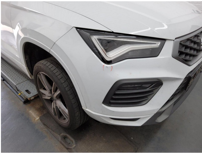
Stoßfänger vorne Lackierung, verschrammt, smart repair (DEKRA)
