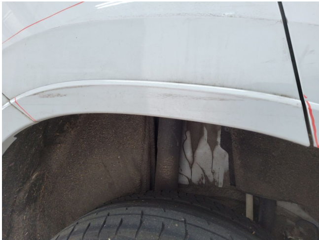
Radlaufabdeckung hinten rechts beschädigt (deformiert) (DEKRA)
