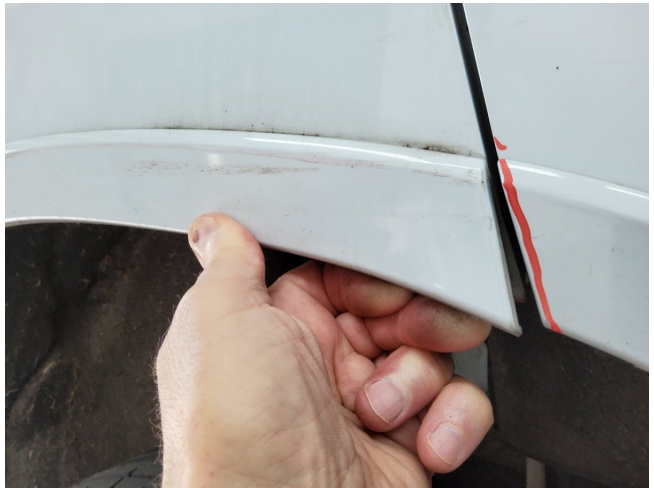
Radlaufabdeckung hinten rechts beschädigt (deformiert) (DEKRA)
