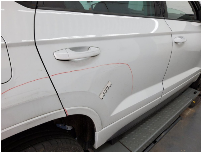
Tür hinten rechts, deformiert, instandsetzen und lackieren mit Lackaufbau (DEKRA)
