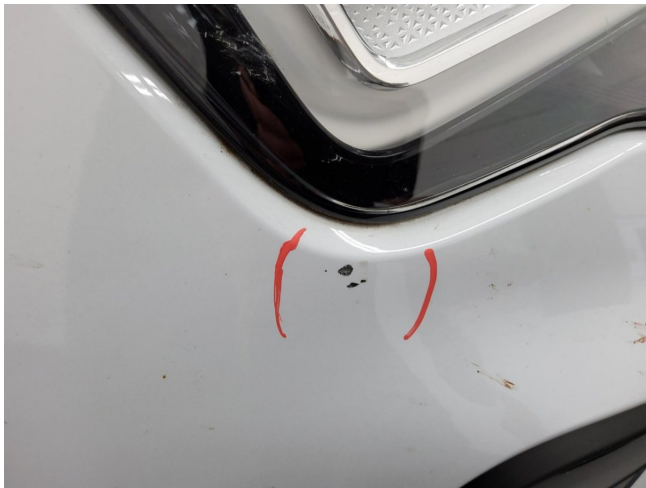
Stoßfänger vorne Lackierung, verschrammt, smart repair (DEKRA)
