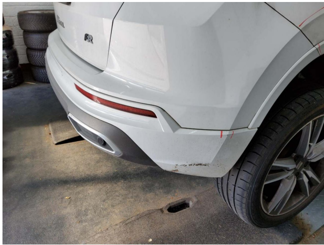
Stoßfänger hinten Lackierung, verschrammt, smart repair (DEKRA)
