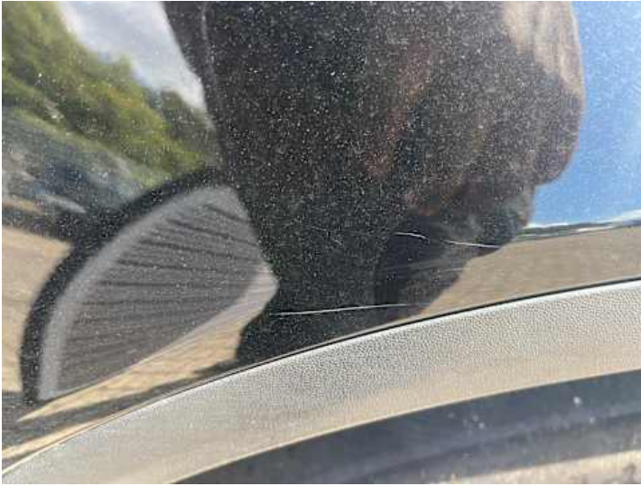
Kotflügel vorne rechts (Kratzer, Lackschaden)
