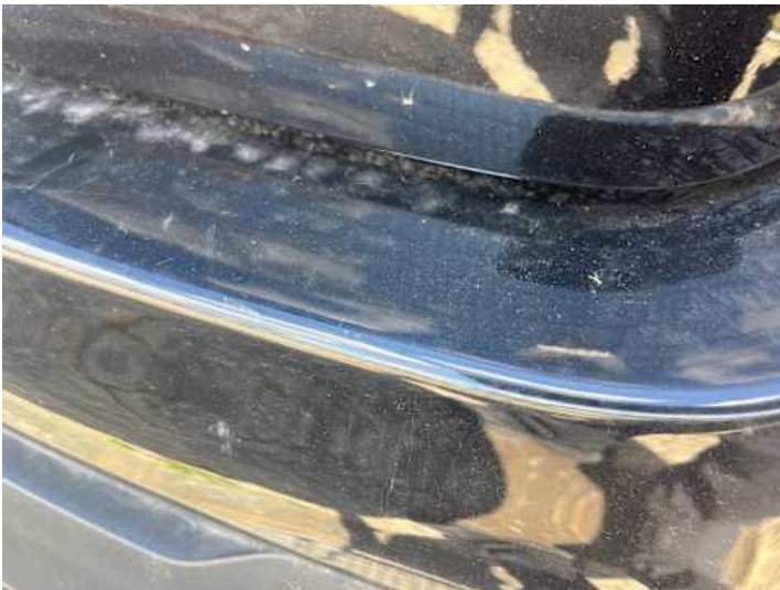
Stoßstange hinten (Verformung, Riss/Bruch)
