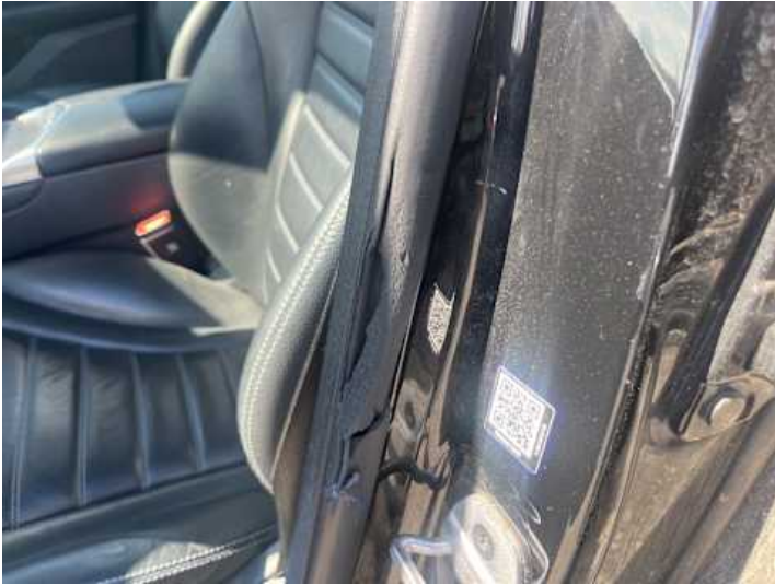
Innenraum (Anderer Schaden): Türdichtung beschädigt
