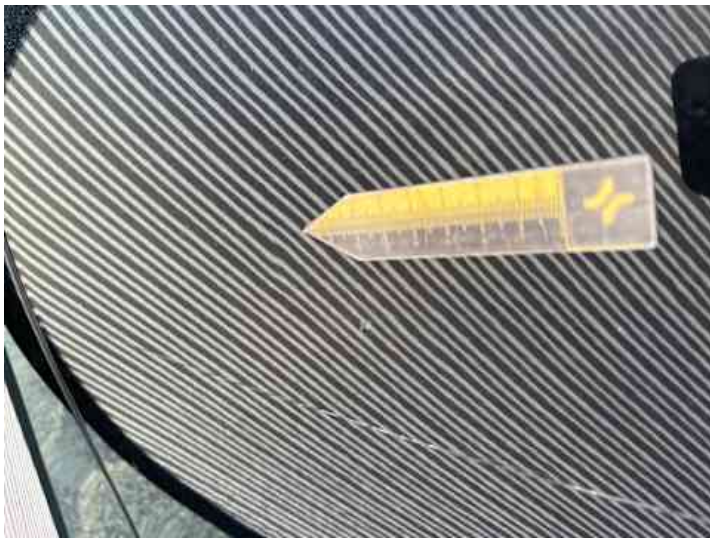
Türe hinten rechts (Delle, Kratzer)
