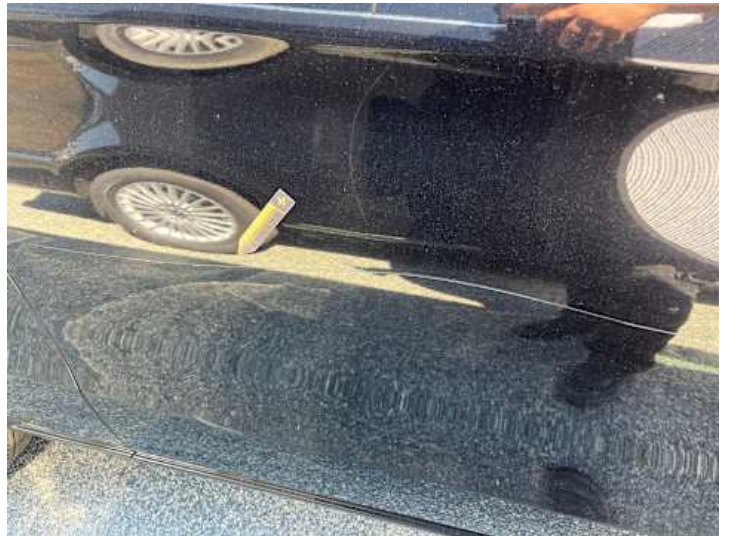
Türe hinten rechts (Delle, Kratzer)
