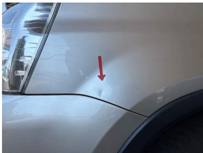
Kotflügel vorne links (Delle, Kratzer)
