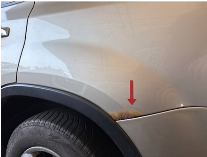
Seitenteil hinten links (Rost)
