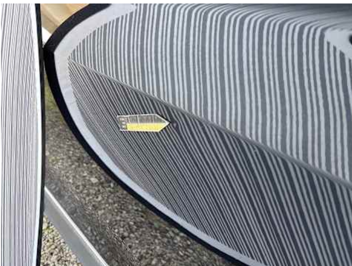
Türe hinten links (Kratzer, Delle)
