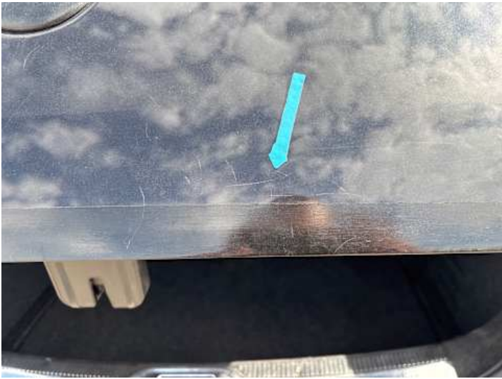
Heckklappe (Unsachgemäß instand gesetzt)
