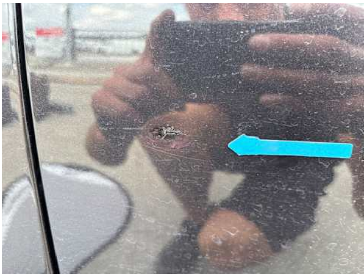
Fahrtür (Delle, Kratzer)
