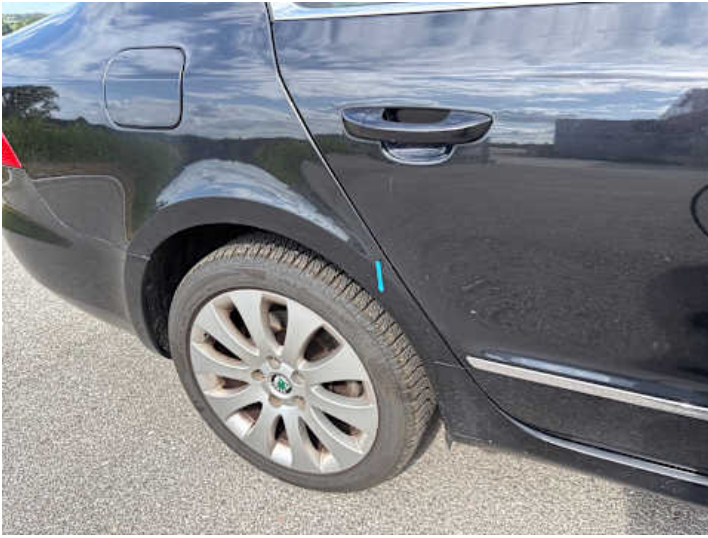
Seitenteil hinten rechts (Unsachgemäß instand gesetzt)
