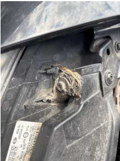
Scheinwerfer (rechts) (Riss/Bruch)
