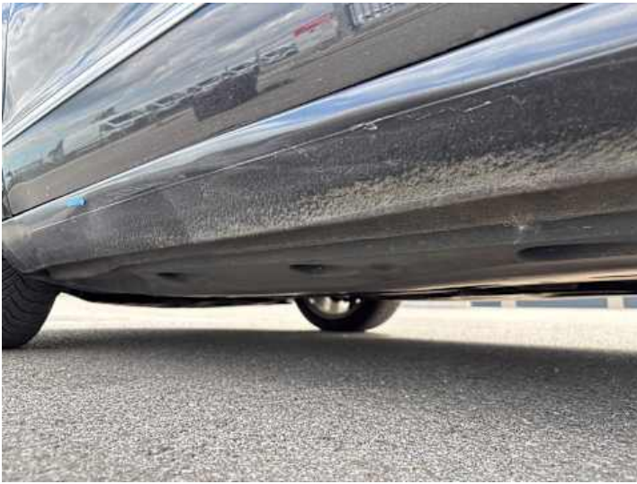
Schweller links (Verformung, Kratzer)
