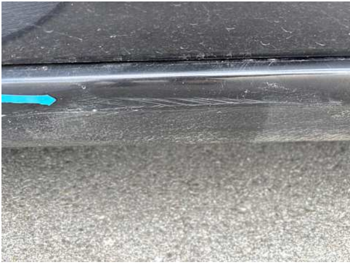
Schweller links (Verformung, Kratzer)
