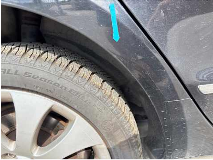
Seitenteil hinten rechts (Unsachgemäß instand gesetzt)
