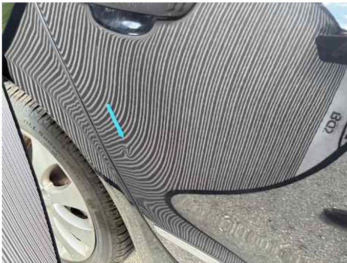
Türe hinten rechts (Delle)
