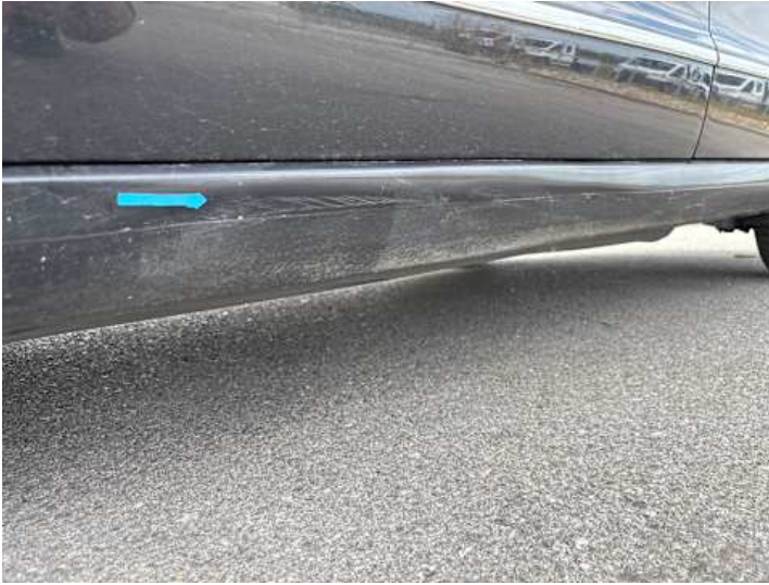
Schweller links (Verformung, Kratzer)
