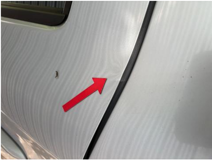
Türe hinten links (Delle)
