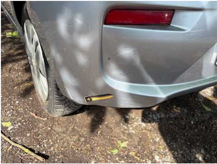
Stoßstange hinten (Kratzer, Lackschaden, Verformung)
