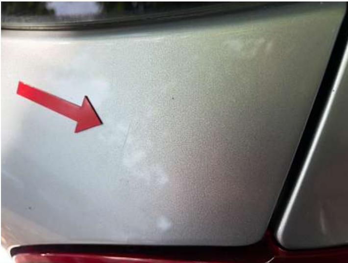
Heckklappe (Kratzer, Lackschaden)
