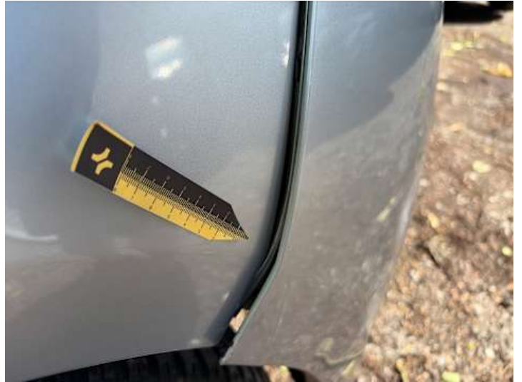
Stoßstange hinten (Riss/Bruch)
