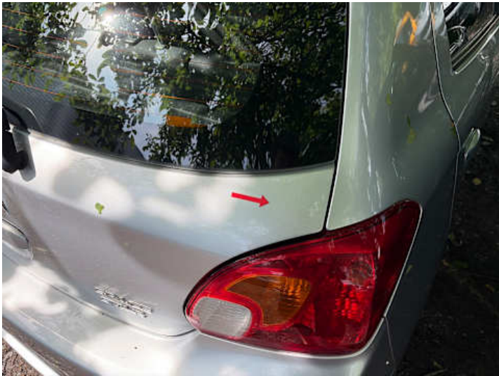
Heckklappe (Kratzer, Lackschaden)
