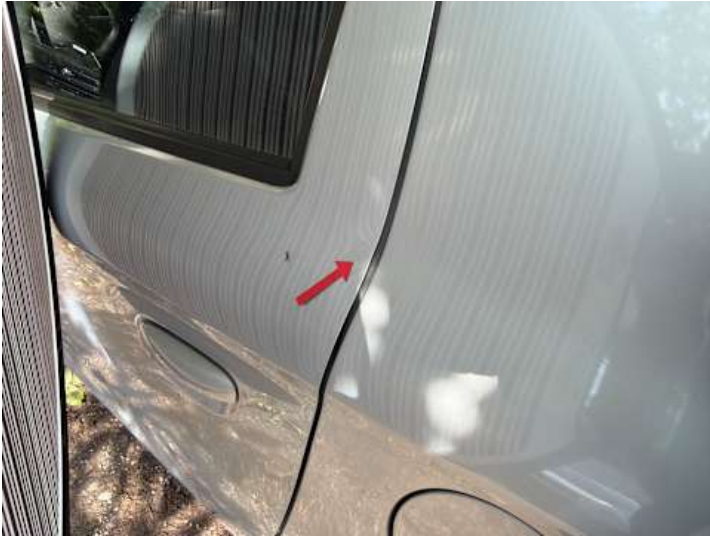
Türe hinten links (Delle)
