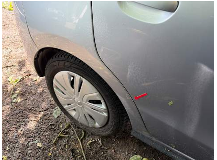
Seitenteil hinten rechts (Lackschaden, Rost, Delle)
