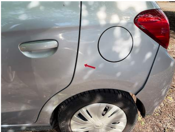
Seitenteil hinten links (Delle, Kratzer, Lackschaden)
