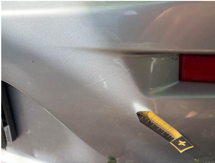
Stoßstange hinten (Kratzer, Lackschaden, Verformung)
