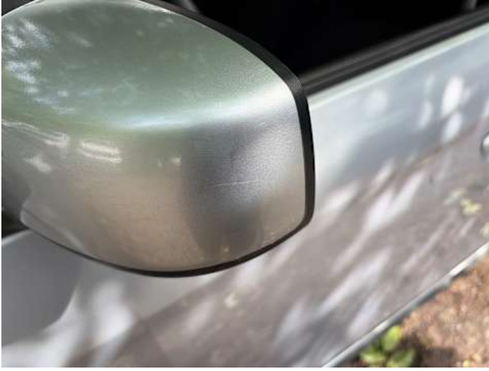
Fahrertür (Delle, Kratzer, Lackschaden)
