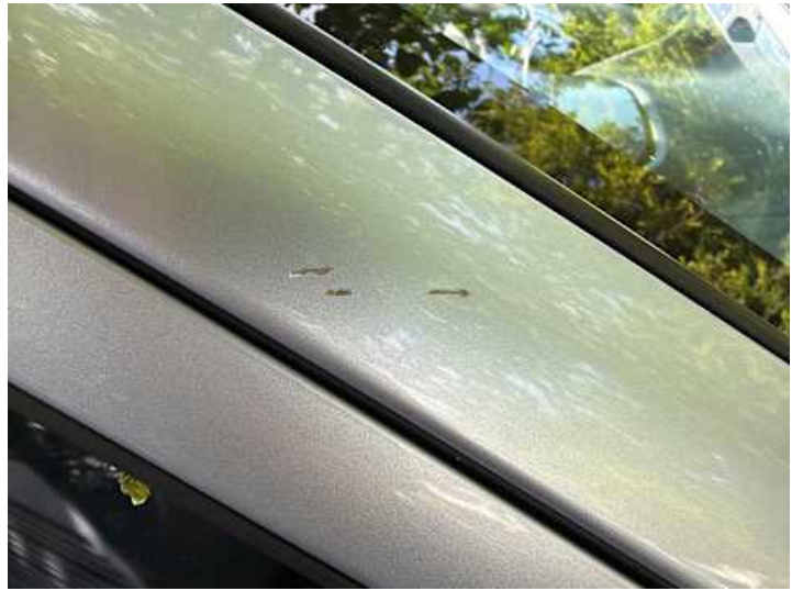
Dach (Lackschaden, Kratzer)
