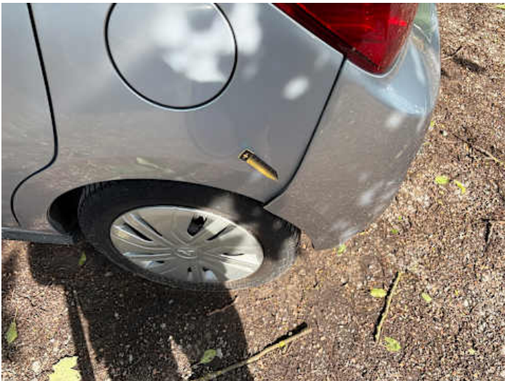
Stoßstange hinten (Riss/Bruch)
