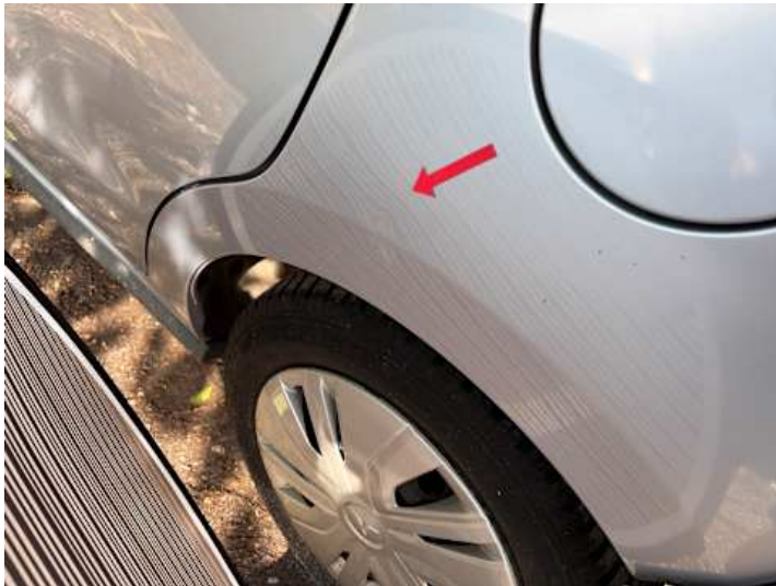
Seitenteil hinten links (Delle, Kratzer, Lackschaden)
