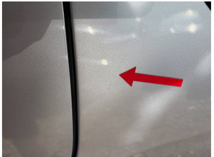
Seitenteil hinten links (Delle, Kratzer, Lackschaden)
