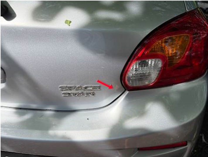
Heckklappe (Kratzer, Lackschaden)
