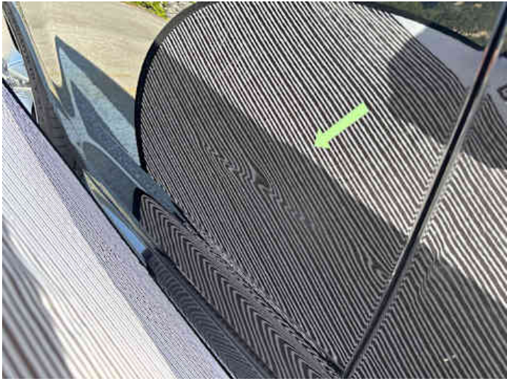
Türe hinten rechts (Verformung, Kratzer)
