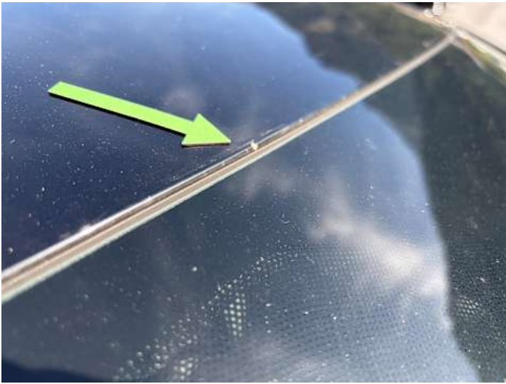
Dach (Steinschlag, Rost)
