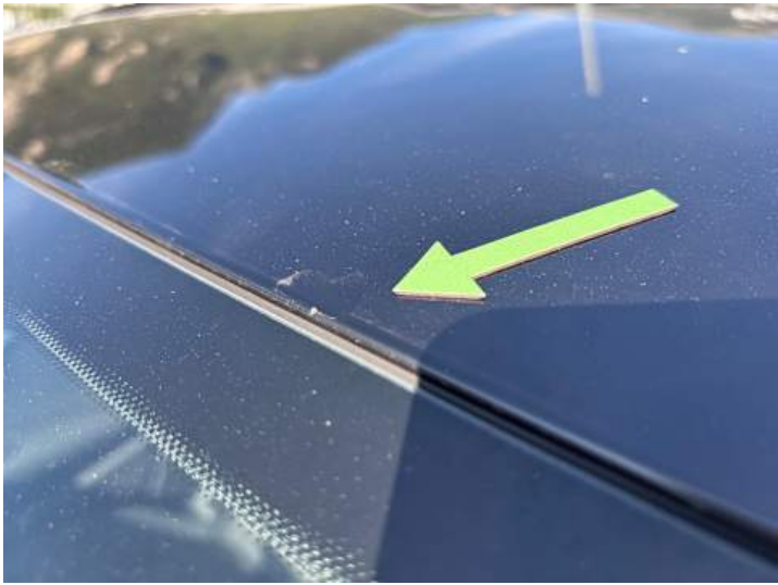
Dach (Steinschlag, Rost)
