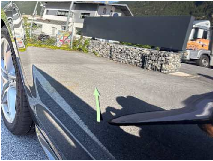
Türe hinten rechts (Verformung, Kratzer)
