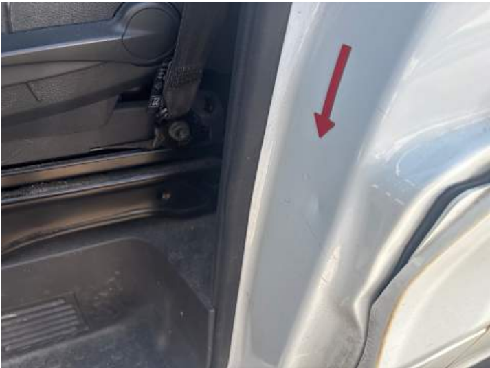
Schweller links (Delle)
