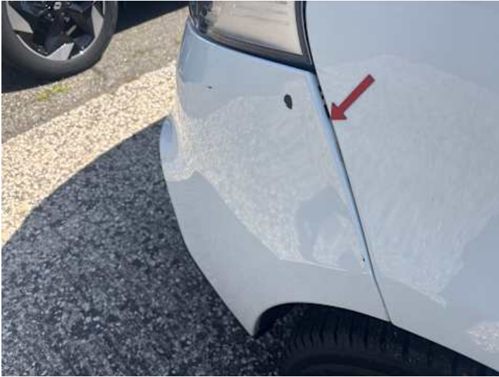
Stoßstange vorne (Kratzer, Spaltmaße ungenau)
