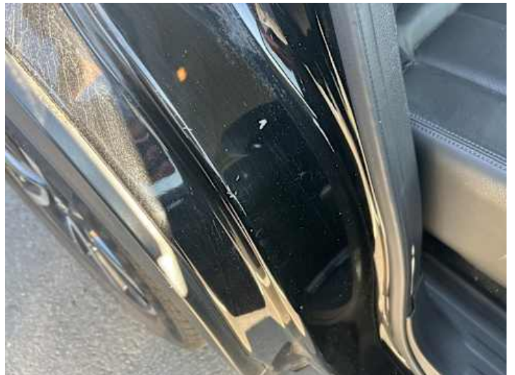
Türe hinten rechts (Delle, Kratzer)
