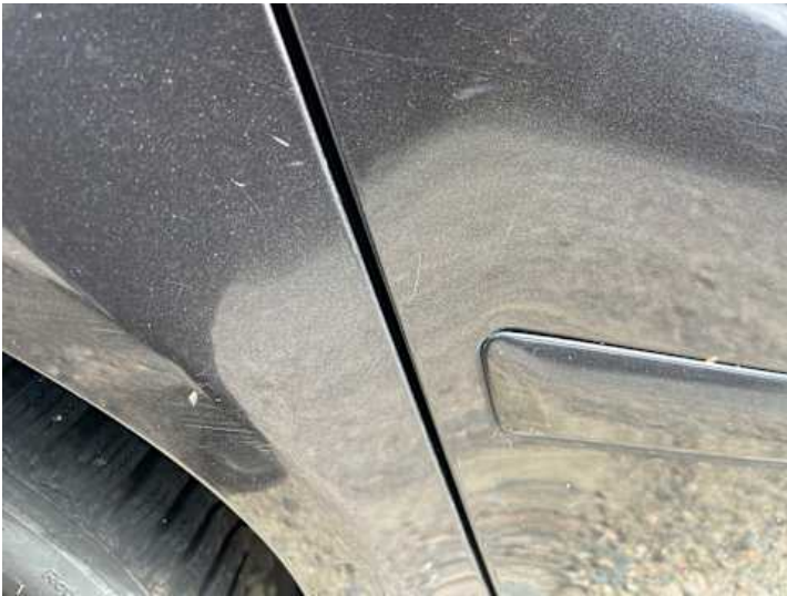
Türe hinten rechts (Kratzer, Lackschaden)
