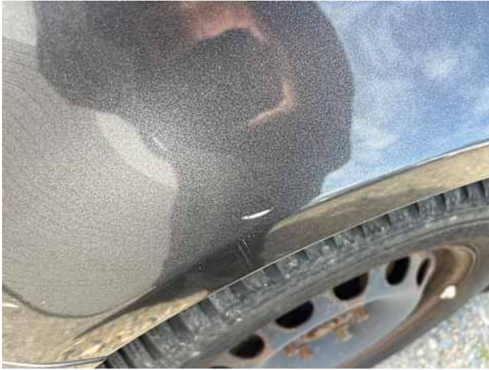
Kotflügel vorne links (Kratzer, Lackschaden)
