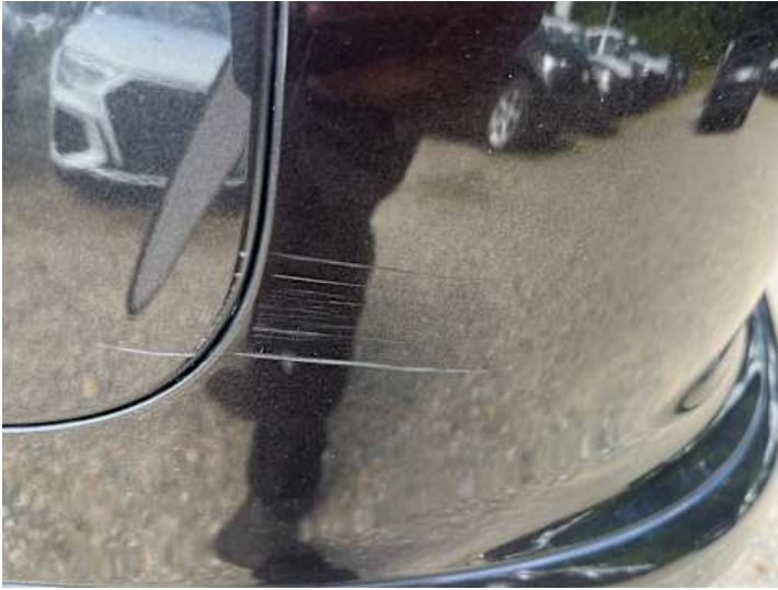
Stoßstange hinten (Kratzer, Lackschaden)
