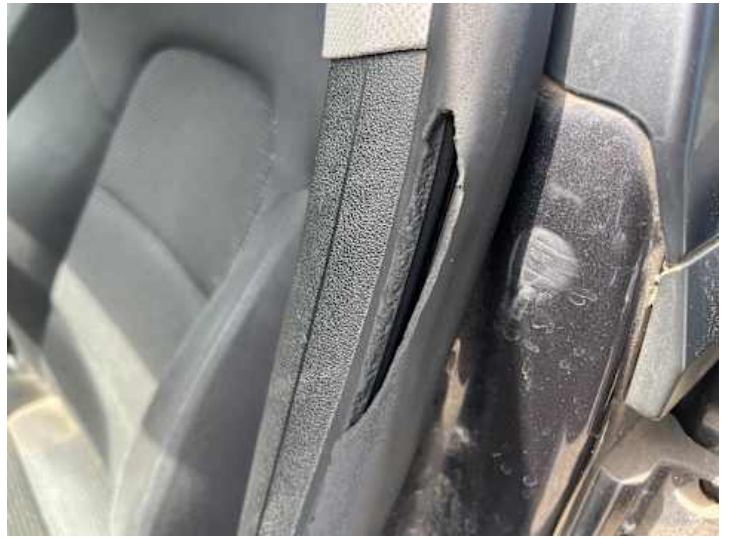
Fahrertür (Anderer Schaden): Türdichtung beschädigt
