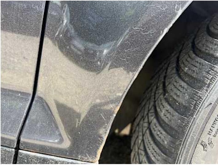
Kotflügel vorne rechts (Lackschaden, Rost)
