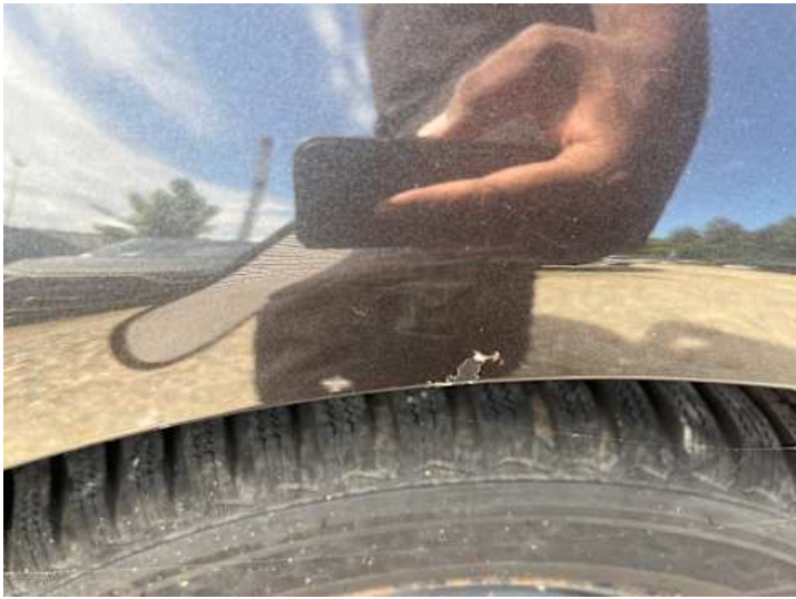
Seitenteil hinten links (Lackschaden, Rost)
