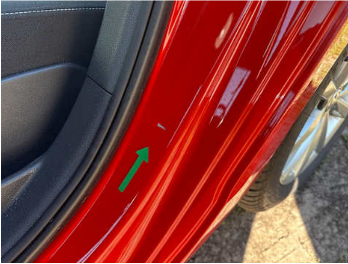
Seitenteil hinten links (Kratzer)
