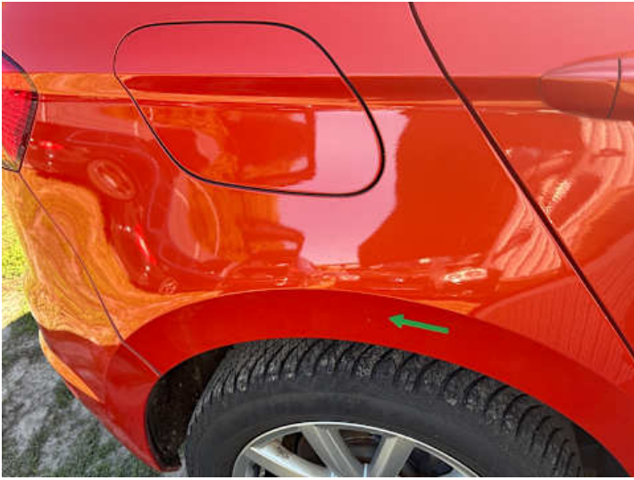
Seitenteil hinten rechts (Delle)
